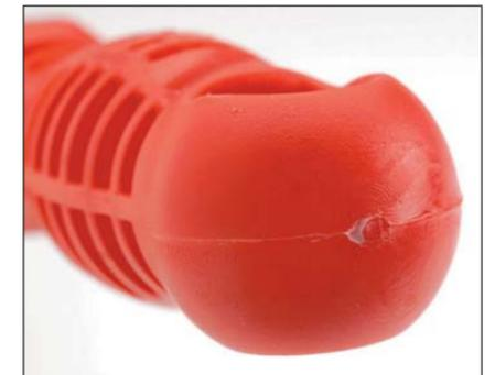
An den Wisent-Griffen störte die unsaubere Verarbeitung: Kleine Grate und Kunststoffspitzen stören vor allem bei längerer Arbeit mit dem Werkzeug
