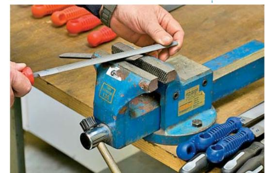
definiertem Material getestet, in unserem Fall an einem stählernen Prüfstück mit der Härte 60 HRC (Härte n. Rockwell). Hinzu kamen wie immer Bewertungen zur allgemeinen Stabilität der Prüflinge sowie zur Ergonomie, die von mehreren Anwendern in praktischen Handhabungsversuchen subjektiv bewertet wurde.
