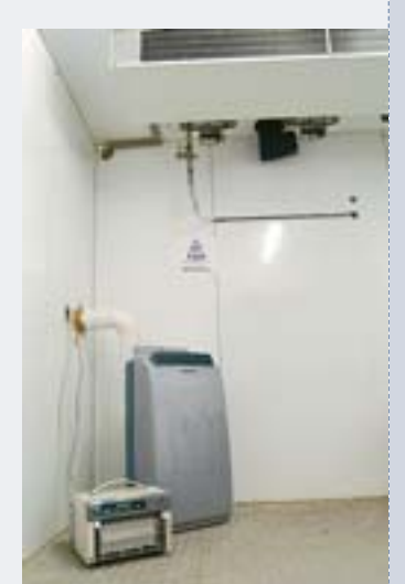
Nicht gerade wohnlich präsentiert sich die Klimakammer, in der beim TÜV Rheinland die Leistungswerte der Klimageräte gemessen wurden. Nur so waren exakt gleiche Testbedingungen für alle Geräte sicherzustellen
