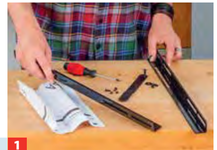
1 Bei dieser Anlage (ELV) ist ein Gestänge zum Aufrichten des Moduls auf einem Flachdach enthalten, es muss nur ...
