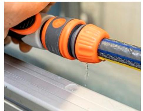
**- UNDICHT:** Die Kupplung von Chuner hielt dem Überdrucktest nicht stand.
