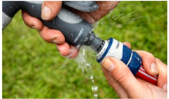
**SPRITZT:** Bei einigen Stopp-Kupplungen (hier Sirocco) tritt beim Kupplungsvorgang kurz Wasser aus.
