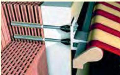
**Für schwere Lasten:** *Thermax 12/16* für Vordächer/Markisen an Außenwänden mit WDVS, gedämmten Deckenstirnseiten, vorgehängten Fassaden; für alle gängigen Baustoffe.
