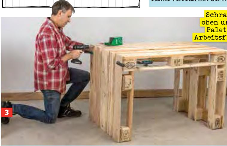
Schrauben versetzt oben und unten in die Palettenklötze der Arbeitsfläche schrauben.
