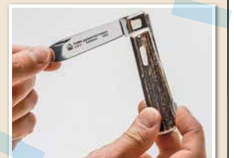
LOCKBACK: Zum Entriegeln wird eine Taste auf dem Rücken gedrückt.
