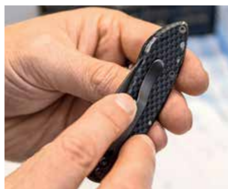
- UNSCHÖN: Fällt das Buck-Messer herunter, platzt der Lack an den Kanten ab.
