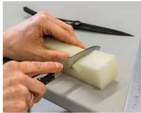
VERGLEICH: An flexiblem Schaumstoff untersuchte die VPA die Schärfe.
