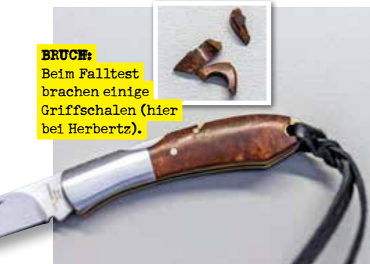
- FALLTEST: Abgebrochene Teile im Handhabungsbereich wurden abgewertet.
