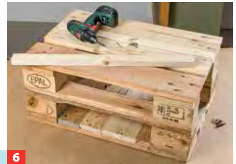
4 Drehen Sie eines der Palettenelemente auf den Kopf und verschrauben Sie die Bretter (ergänzt um ein Reststück) lückenlos.
