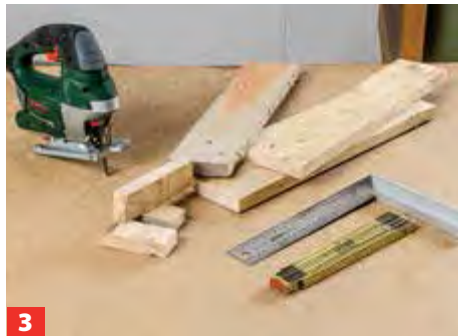
1 Trennen Sie zwei Paletten jeweils längs und quer, sodass Sie zwei Elemente mit jeweils vier Klötzen und drei Brettern erhalten.
