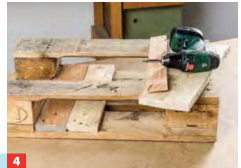
2 Demontieren Sie drei Bretter der restlichen Palettenstücke und entfernen Sie dabei auch die alten Nägel.
