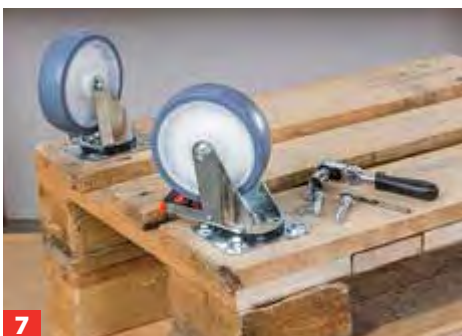
7 Drehen Sie den Tisch auf den Kopf und schrauben Sie an den Ecken die Lenkrollen an (ggf. mit Feststeller).
