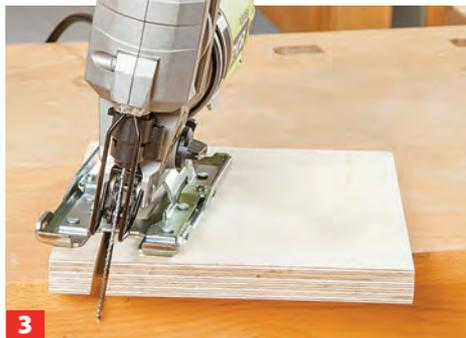
3 Bei der senkrechten Rampenstütze oben ebenfalls einen 7-Grad-Schnitt anlegen – die Höhe hängt von der Rampenlänge ab.
