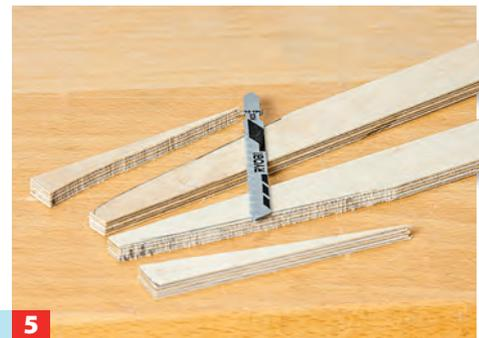
5 Die angezeichneten Ecken schneiden Sie dann mit der Stichsäge ab.
