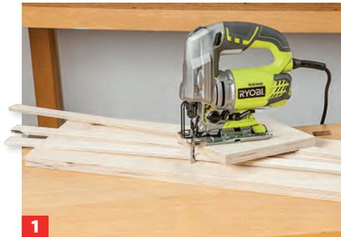
1 Schneiden Sie die Bauteile für die Rampe aus dickerem Multiplex (z. B. 12 bis 18 mm) zu, nur die Seiten bestehen aus 6,5er Material.
