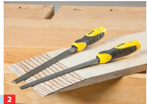
2 Die Rampenfläche wird unten auf etwa 7 Grad mit Raspel, Feile und Exzentrerschleifer abgeschragt.
