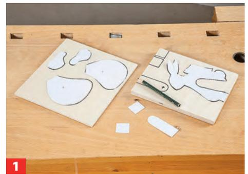
**1** Zeichnen Sie die Umriss der Hasen-Bauteile auf 12- (innen) bzw. 6,5-mm-Multiplex (außen).
