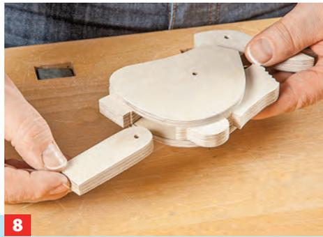
**8** ... Millimeter schmäler. Sollen die Lauftiere bemalt werden, die Lackdicke berücksichtigen! Nun schieben Sie das Hinterbein ein, ...
