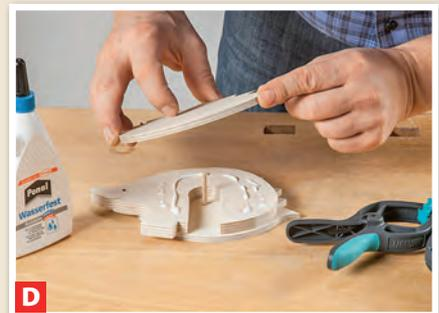
**D** Auch hier gilt: Dübelstange zum Zentrieren beim Verleimen verwenden. Leimen Sie auch später die Dübelstange nicht ein.
