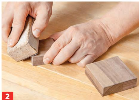
**2** Flächen und Sägeschnitte sorgfältig schleifen und die Kanten (bis auf die oberen Kanten des Sockelholzes) gleichmäßig brechen.
