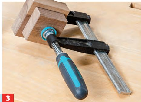
**3** Mit wasserfestem Holzleim die Bauteile zentriert verleimen. Abgekniffene Drahtstifte schützen vor Verrutschen im Leimbett!
