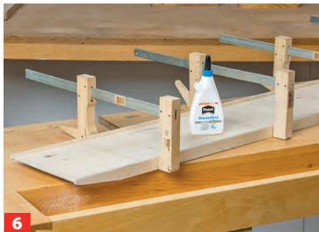
6 Anschließend leimen Sie die „Banden“ auf. Sie sollten etwa 10 mm überstehen.
