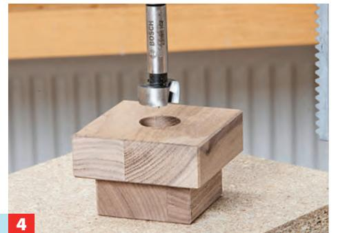
**4** Exakt mittig (Mittelpunkt über die Diagonalen ermitteln) bohren Sie senkrecht ein 25-mm-Loch durch die obere Holzlage.
