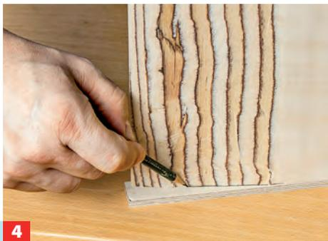
4 Legen Sie nun die seitlichen Leisten bündig an die untere Fläche der Rampe und zeichnen die 7°-Schräge der Auslaufzone an.
