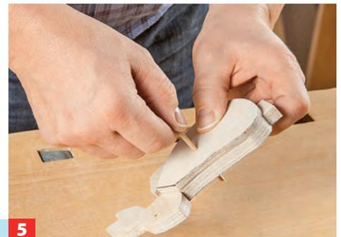
**5** Zum Verleimen der drei Flächen stecken Sie leimlos ein Stück Dübelstange durch die beiden Außenflächen, um diese ...
