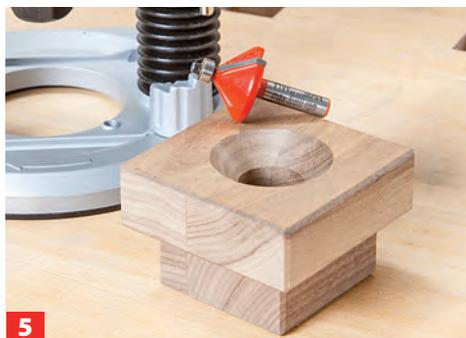
**5** Eierbecher einspannen und mit dem 45°-Fasensfräser schrittweise 10 mm tief an der Bohrung entlang in der Innenwand fräsen.
