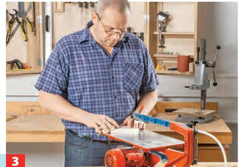
**3** Einfacher geht das mit einer Dekupiersäge, z. B. von Hegner. Dann schleifen und entgraten Sie die Bauteile.
