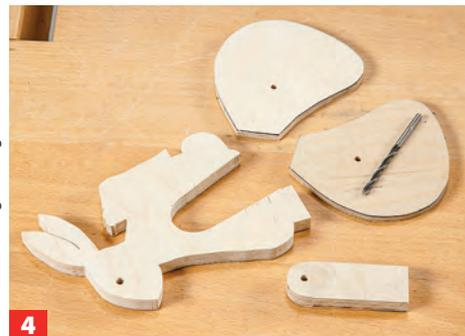
**4** Bohren Sie anschließend die 4- bzw. 5-mm-Löcher\* für die Aufhängung des Hinterbeins und für das Auge.
