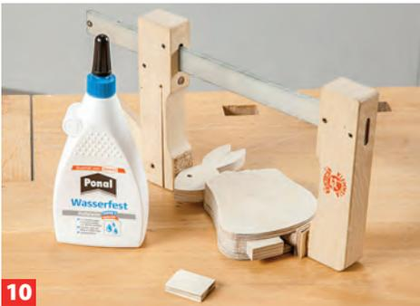
**10** Die an der Unterseite leicht konvex geschliffenen Füße aufleimen. Tipp: die Arme zunächst mit Doppelklebeband fixieren ...
