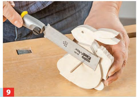
**9** ... stecken die 4-mm-Dübelstange durch und längen sie bündig ab. Das Hinterbein muss nun völlig frei pendeln können.
