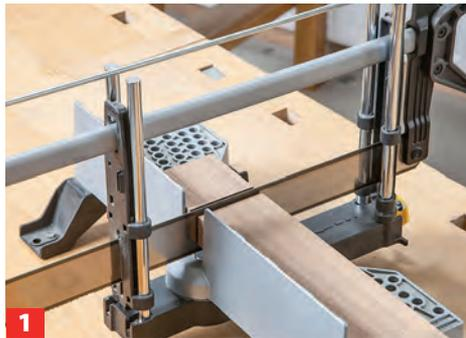
**1** Schneiden Sie pro Eierbecher ein Sockelholz 60 x 60 mm und ein Deckelholz 80 x 80 mm zu.
