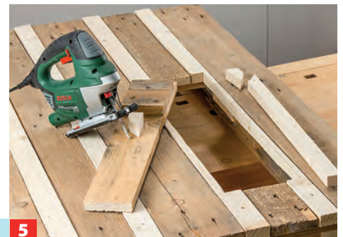
Nun mit der Stichsäge ca. 1 cm nach innen versetzt das Rechteck ausschneiden. So liegt der Kastenrand später auf dem Tisch auf.
