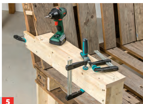
5 Ebenfalls analog zum Sessel wird das seitliche Stütz Brett angepasst und befestigt, dann die obere Armlehne angebracht.
