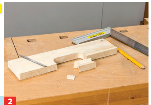
In das Frontbrett des Kastens zwei Löcher mit dem Forstnerbohrer bohren, diese mit der Stichsäge zu einem Griffloch erweitern.
