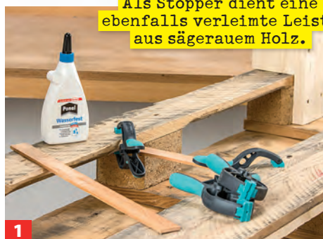
Den Tisch auf die Platte legen und dünne Leisten aufleimen, auf denen sich die Schubladen später leichter verschieben lassen.
