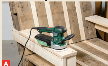
Vor dem Grundieren und Lasieren werden die Oberflächen sorgfältig geschliffen.
