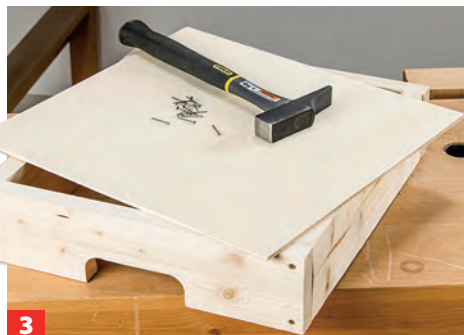
Vier Bretter stumpf zu einem Kasten verschrauben, dann die Bodenplatte aus Sperrholz annageln. Die Lücken in der ...
