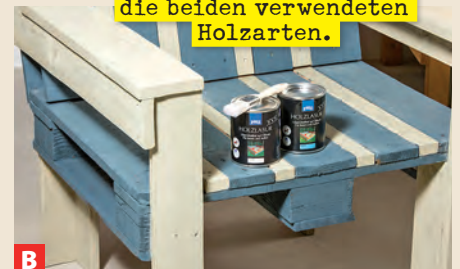
Mit farbiger Lasur (hier von PNZ) mindestens zweimal streichen (Zwischenschliff).
