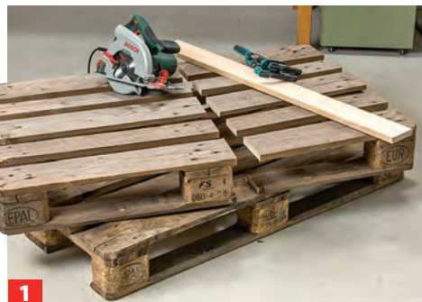
1 Für dieses Projekt brauchen Sie zwei Paletten. Beide wie den Sessel unter Berücksichtigung der Klötze gerade durchsägen.
