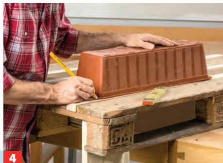
... Tischplatte werden mit Leisten gefüllt. Den Blumenkasten umdrehen, gemäß Zeichnung auflegen und die Umriss markieren.
