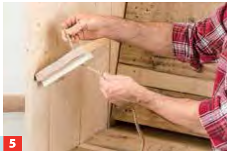
2 Für die Tisch-Aufhängung wird in der Stärke des verwendeten Seils ein Loch in die vordere Leiste und die Tischplatte gebohrt.
