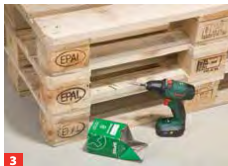
1 Drei Paletten zusammenzwängen und Ausschnitte für die Fußstützen jeweils zwischen den Klötzen anzeichnen.
