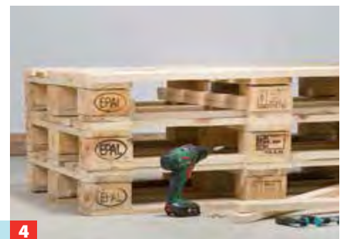
4 In die obere Palette werden pro Seite jeweils zwei Laufleisten angebracht, die als Führung für die Fußstützen dienen.
