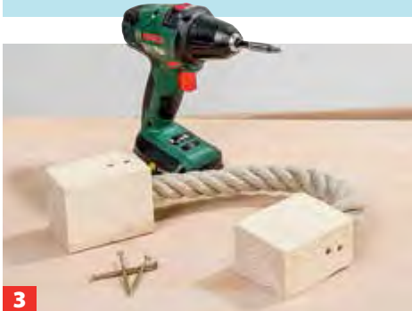
1 Holzklötze zuschneiden und mit einem Forstnerbohrer ein Sackloch in der Stärke des verwendeten Taus bohren.
