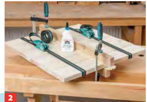
2 ... Schalbretter mit etwas Übermaß grob ab und verleimen die Teile anschließend wie oben gezeigt zu Platten*. Gut verpressen!
