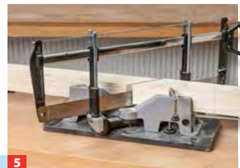
5 Schneiden Sie nun aus den Rahmenhölzern zunächst die vier Fuß-Elemente mit der Präzisions-Gehrungssäge zu.
