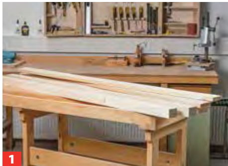
1 Der Sessel besteht aus Fichte/Tanne-Rahmen 58 x 78 mm und aus Schalbrettern 23 x 100 mm. Längen Sie zunächst die ...
