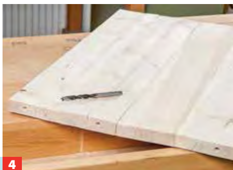
4 Anschließend bohren Sie 8-mm-Dübellöcher in die Kopfholz-Schnittkanten – in der Regel sollten vier Dübel pro Seite reichen.
