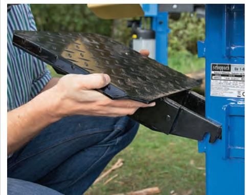
**+** **VERSTELLBAR:** Der Spalttisch bei Scheppach ist werkzeuglos montierbar.
