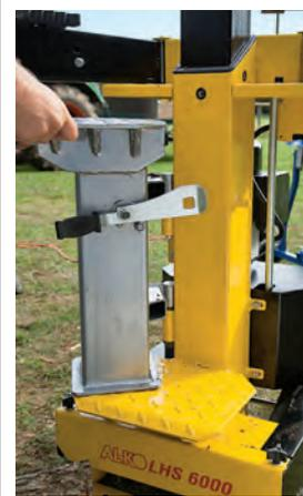
**+** **KLAPPBAR:** Bei Al-Ko kann der Spalttisch einfach aus dem Gerät gedreht werden – so entsteht im Handumdrehen Platz für langes Meterholz.
