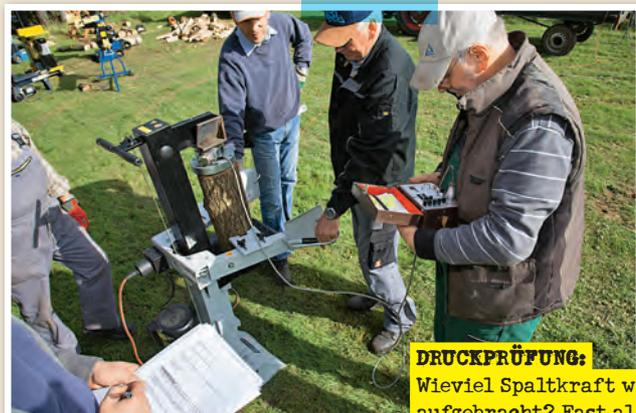
**DRUCKPRÜFUNG:** Wieviel Spaltkraft wird tatsächlich aufgebracht? Fast alle Hersteller schummeln bei den entsprechenden Angaben in der Gebrauchsanleitung.
