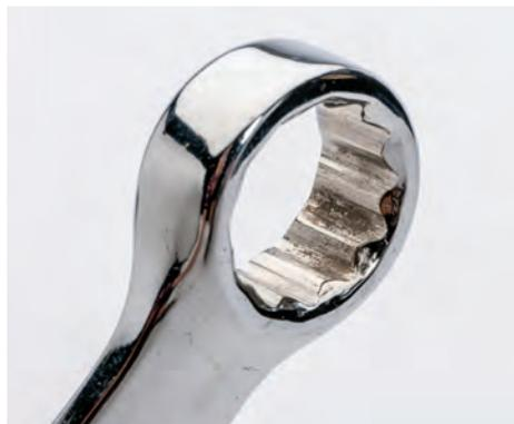
**FEHLERHAFT:** Im Inneren des Ringprofils ist die Verchromung unzureichend (Stanley).
