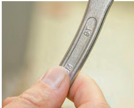
**KRUMM:** Dieser Dema-Schlüssel verbog sich bei Nennlast dauerhaft.
