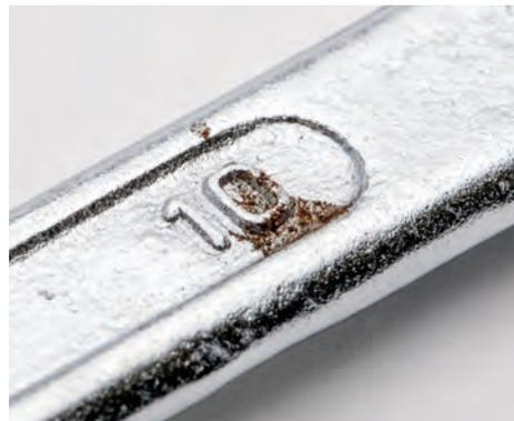
**ROST:** Korrosion verunstaltet die auch sonst raue Oberfläche bei *Dema*.
