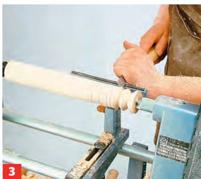
1 Mit dem Drehmeißel wird nun die Oberfläche „geschlichtet“.
