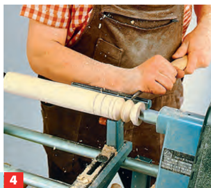
2 Kerben werden mit der Spitze des Drehstahls eingeschnitten.
