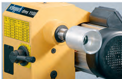
Das Spundfutter gibt's in verschiedenen Durchmessern. Es hält das Werkstück beim DrehSELn von vorn.
