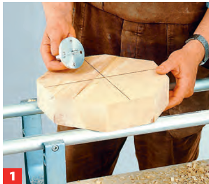
1 Beim Querdreheln wird ein Schraubfutter genau in der Mitte des grob ...
