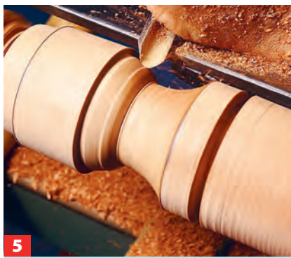
3 Kerben und Kehlen immer vom äußeren Rand zur Talsohle schneiden, ...
