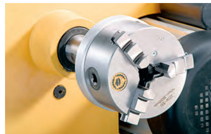
Die Wendebacken dieses Spannftutters können einen DrehSELrohling von innen und von außen halten.
