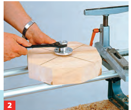
2 ... zurechtgestrichenen Werkstücks montiert und am Spindelstock befestigt.
