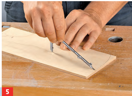
2 Damit das Holz nicht ausreißt, wird die obere Furnierschicht mit dem Cutter angeritzt.
