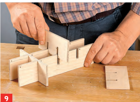
7 Boden, Deckel und Zwischenwände aufeinander ausrichten – exakt in der Position, in der sie später liegen!
