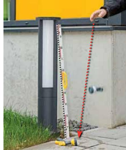
**FALLTEST:** Aus einem Meter Höhe auf Beton – kein Problem für alle Produkte.
