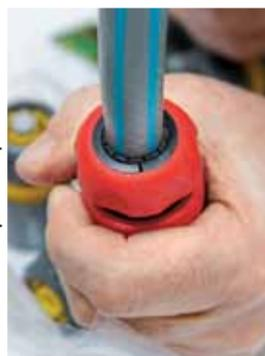
**UNDICHT:** Die Metallkupplungen von Kärcher versagten im Überdruck-Test.
