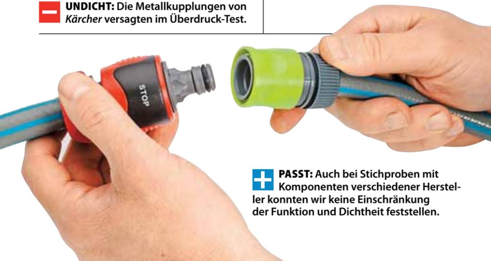
**PASST:** Auch bei Stichproben mit Komponenten verschiedener Hersteller konnten wir keine Einschränkung der Funktion und Dichtheit feststellen.
