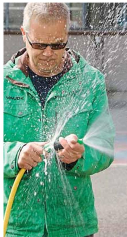
**NASS:** Bei Pro Garden funktioniert die Stoppkupplung nicht bestimmungsgemäß.
