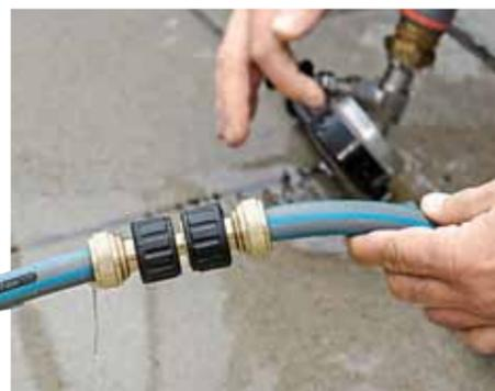
**GERISSEN:** Dreht man die Verschraubung bei Mr. Gardener komplett zu, reißt der innere Klemmring. Die Verbindung ist immerhin dennoch dicht.
