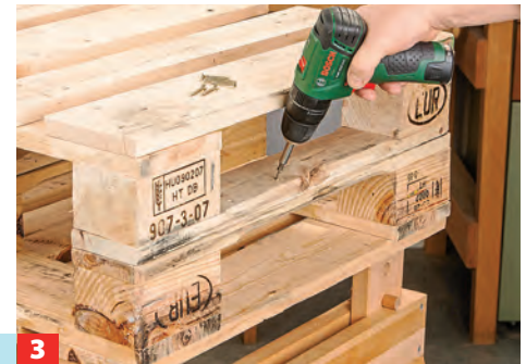
3 Dann werden die beiden Palettenteile Unterseite an Unterseite seitlich miteinander verschraubt.
