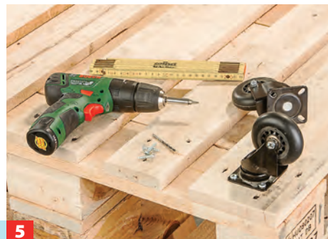
5 Den Tisch herumdrehen und an allen vier Ecken die Möbelrollen anbringen.
