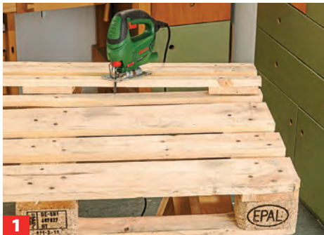
1 Die Paletten auf das gewünschte Maß zuschneiden, miteinander verbinden und die Extra-Füße anbringen (siehe Kommode).
