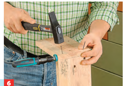
6 Aus einzeln zugeschnittenen Paletten-Brettern werden die beiden Sammelboxen gebaut. Alle Seitenteile zusammennageln.
