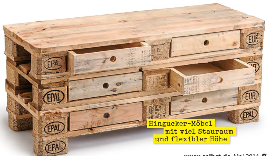
6 Die Front der Schubladen erhält mit einem Forstnerbohrer ein Loch als einfachen Griff.
