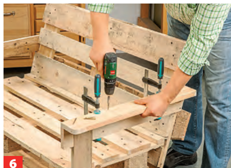
6 Als Armablage dient ein waagrecht angebrachtes Brett. Die Ecken auch hier sorgfältig rund feilen.
