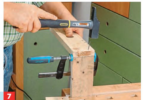
4 Schneiden Sie aus Palettenholz passende Füllleisten zu und nageln Sie diese fest. Ecken und Kanten mit der Feile abrunden.
