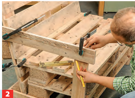
2 Aus einigen Brettern zwingen Sie die Armlehnen zuerst probeweise zusammen und zeichnen die Ausklinkungen an.
