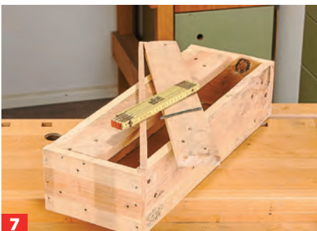
7 Der Boden besteht aus zwei passgenau zusammengesetzten Palettenbrettern, diese ebenfalls annageln.
