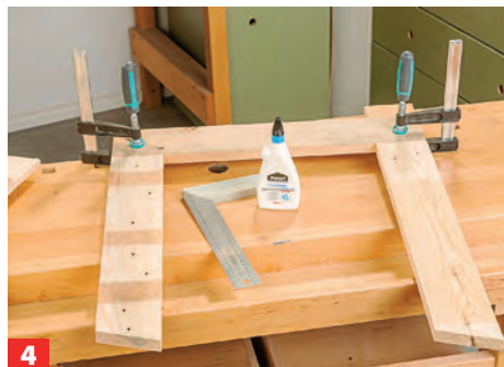
2 Aus einigen Brettern zwingen Sie die Armlehnen zuerst probeweise zusammen und zeichnen die Ausklinkungen an.
