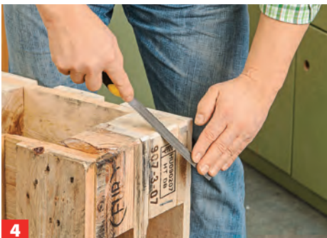
4 Mit einer groben Feile die Ecken und Kanten abrunden, das sieht schöner aus und vermindert die Splittergefahr.
