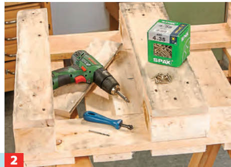
2 Damit die beiden Boxen später leicht rein- und rauszuschieben sind, werden von unten Bretter als Laufleisten verschraubt.
