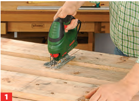
1 Legen Sie die gewünschte Tischbreite fest, zeichnen Sie diese an und teilen Sie die Paletten mit der Stichsäge.
