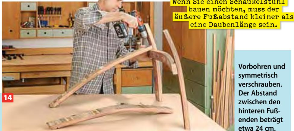
**14** Vorbohren und symmetrisch verschrauben. Der Abstand zwischen den hinteren Fußenden beträgt etwa 24 cm.
