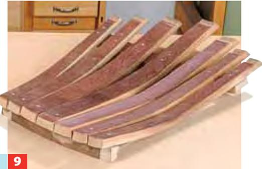
**9** Die Lehne selbst wird unten abgelängt. Die Hölzer sollten die untere Strebe etwa um Materialstärke überragen.
