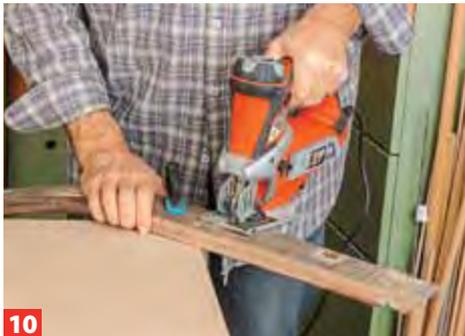
**10** Kürzen Sie nun die Dauben für das Untergestell. Die drei H-förmig zu verschraubenden Elemente werden an beiden Enden ...
