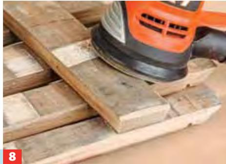
**8** Die Schnittkanten fasen Sie mit dem Exzenterschleifer leicht an.
