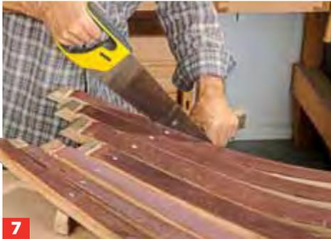
**7** Längen Sie jetzt die seitlich überstehenden Streben mit einer geeigneten Handsäge (z. B. mit einem Fuchsschwanz) bündig ab.
