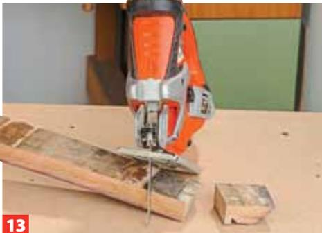
**13** Schneiden Sie sie schräg und nur am oberen Ende zu. *Tipp:* Die erste Daube sollten Sie als Schablone für die zweite verwenden.
