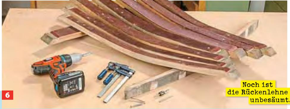
**6** Auch die Streben selbst sollten im Schrauben-Kerndurchmesser vorgebohrt werden. Anschließend drehen Sie alle Schrauben mit wohl-dosiertem Drehmoment ein.
