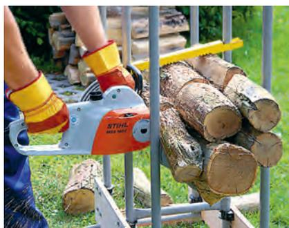
Effizient wird ein halbes Dutzend Stämme mit einem Schnitt getrennt
