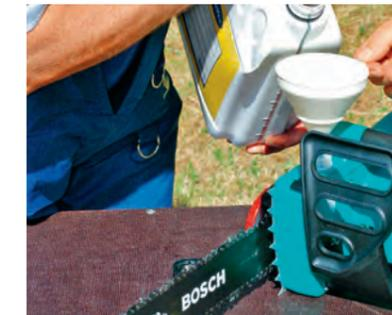
**KETTENÖL:** Auch bei elektrischen Kettensägen regelmäßig den Ölstand prüfen.
