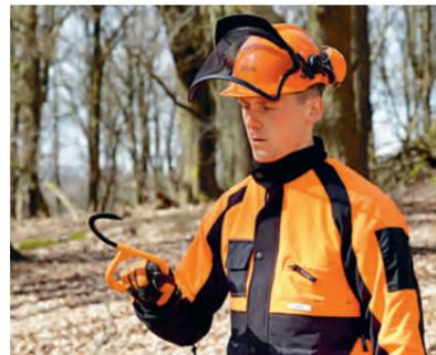
**DORN:** Dieses einfache Werkzeug spart Kraft beim Heben von Holzabschnitten.
