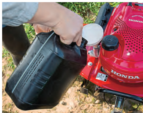
- KNIFFLIG: Bei Honda liegt der Ölstützen sehr nahe an Gehäuseteilen.
