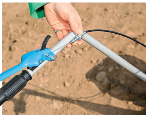
- GEFÄHRLICH: Der Stopphebel für das Hackwerkzeug löst bei Güde nicht sicher aus.
