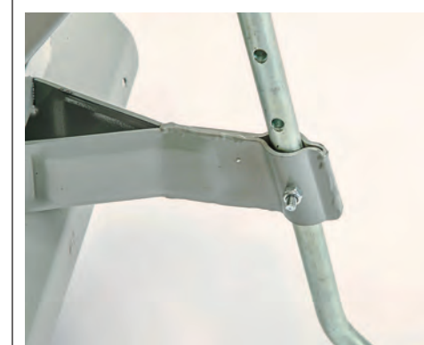
- UMSTÄNDLICH ist die Verstellung mit Schraubverbindung bei Güde.
