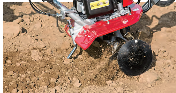
+ GLEICHMÄSSIG: Die kompakte Honda-Hacke ist einfach führbar und liefert auf vorgelockerten Flächen feinkrümeligen Boden.
