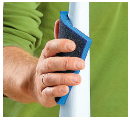
FLEXIBEL: Kontur-Schleifpads passen sich der Werkstückoberfläche an.
