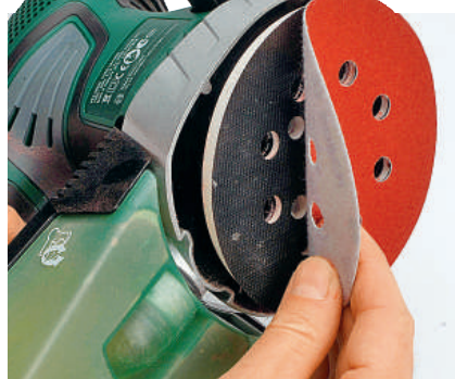
ANHÄNGLICH: Üblich ist eine Klettverbindung zum Schleifschuh des Geräts.
