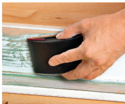
PRAKTISCH: Kunststoff-Schleifhilfen sind flacher und griffiger gestaltet.
