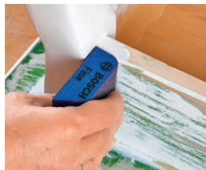
KANTEN: Schleifschwämme helfen beim Abtrag an Innenkanten und in Profilen.
