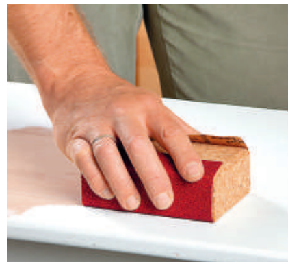
SCHLECHTER: Beim Schleifen quer zum Papier kann das Schleifmittel umschlagen.
