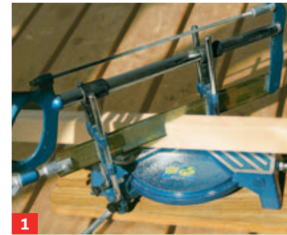
1 Aus Kantholz (25x45 mm) den Rahmen im 45°-Winkel zuschneiden: je zwei Seiten mit 700 bzw. 1100 mm Länge.
