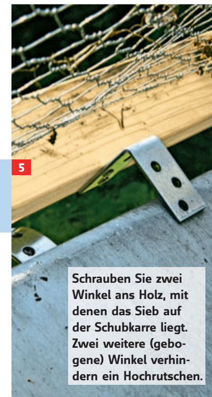
2 Verleimen Sie die vier Seitenteile und versehen das Holz außen zusätzlich mit Metallwinkeln.
