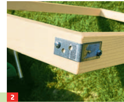
2 Verleimen Sie die vier Seitenteile und versehen das Holz außen zusätzlich mit Metallwinkeln.
