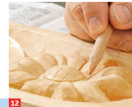
12 Fasern, die sich dabei aufstellen, einfach mit einem angespitzten Buchenrundholz niederdrücken
