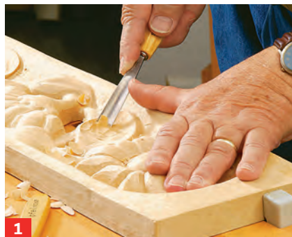
1 Das gewölbte Blatt des Blumenrohlings wird ausgehöhlt: Das Hohleisen geht in die Tiefe. Linken Daumen ...
