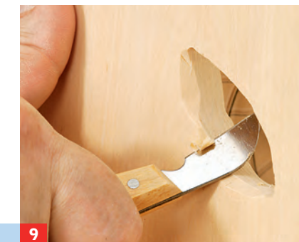
9 ... Rahmens säubern. Das Relief wenden und die Öffnungen mit einem Schnitzmesser abrunden.
