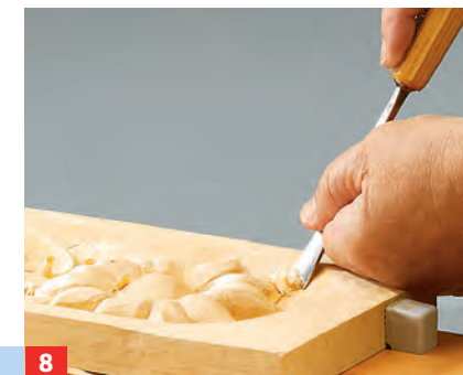
8 Die rechte Hand steuert, die linke kontrolliert die Bewegungen. Mit dem Blumeneisen den inneren Teil des ...
