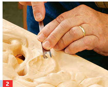
2 ... als Anschlag nutzen. Ein flacheres Hohleisen setzt die Arbeit fort. Zwei Finger liegen dabei fest auf.
