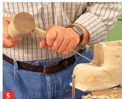
5 Außenkonturen grob zurichten, ggf. Klüpfel verwenden. Lasche mit Geißfuß und Hohleisen anlegen.
