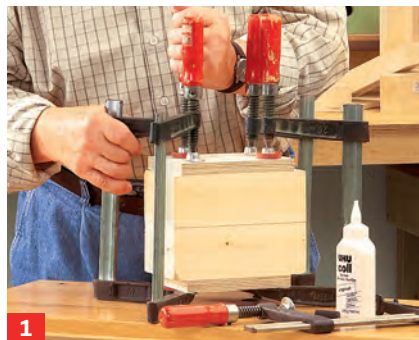
1 Zwei flache Hölzer bilden verleimt ein hohes Rechteck. Plane Flächen herstellen und fest verpressen!
