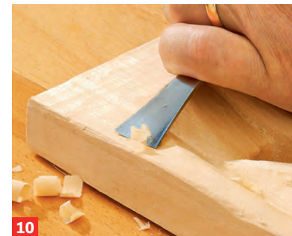
10 Zum Schluss den Relieffahmen mit einem flachen Blumeneisen glätten. So lassen sich Unebenheiten und ...
