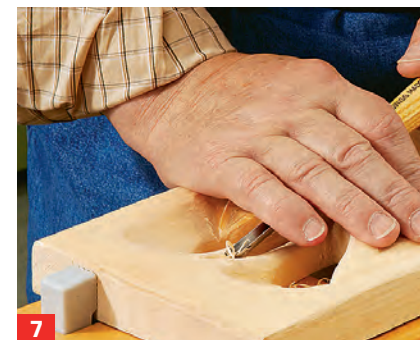
7 V-förmiger Geißfuß oder schlankes Hohleisen verbreitern den Abstand zwischen den Blumenstielen.
