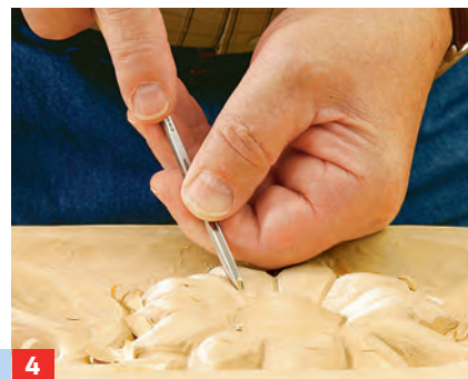
4 ... anpasst. Ein schlankes Hohleisen oder der V-förmige Geißfuß ziehen Linien zwischen die Blütenblätter.
