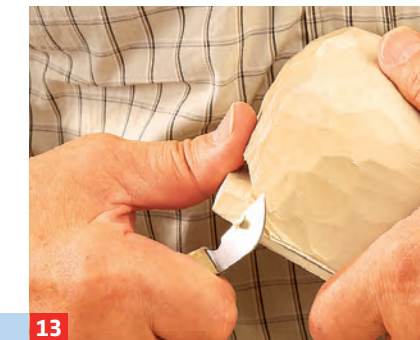
13 Die Sohle ausschnitzen und alle Flächen glätten. Auch die hintere Schlaufe in Form bringen.
