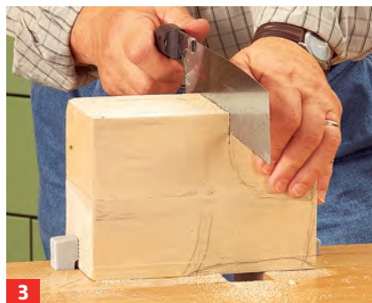
3 Die grobe Form entsteht, indem Sie den Überstand mit der Säge wegschneiden oder wegstemmen.
