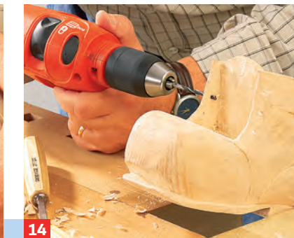
14 Die Löcher für die Schnürsenkel nicht vergessen: Schuh einspannen und mit der Bohrmaschine bohren.
