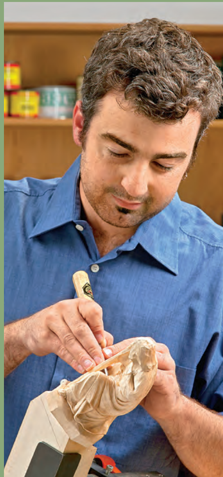
1 Den Rohling für maximale Beweglichkeit in einer solchen Kugelgelenk-Einspannvorrichtung fixieren.
