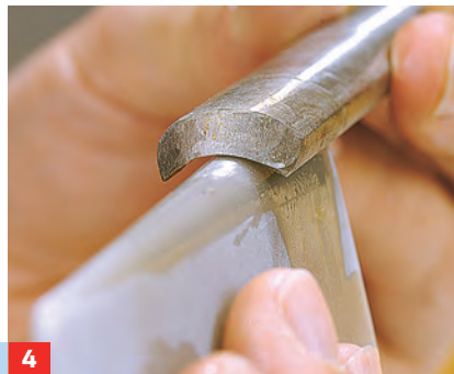
4 ... und dann vorsichtig flach auf der Innenseite des Eisens einige Male hin und her bewegen.
