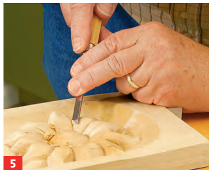
5 Dann wird die Blüte Blatt für Blatt mit einem Balleisen abgerundet. Halten Sie das Eisen wie einen Stift.
