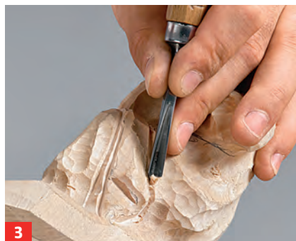
3 ... zurichten, dann mit dem geraden Geißfuß (75°, etwa 6 bis 8 mm) die Hauptfalten schichtweise ausarbeiten.
