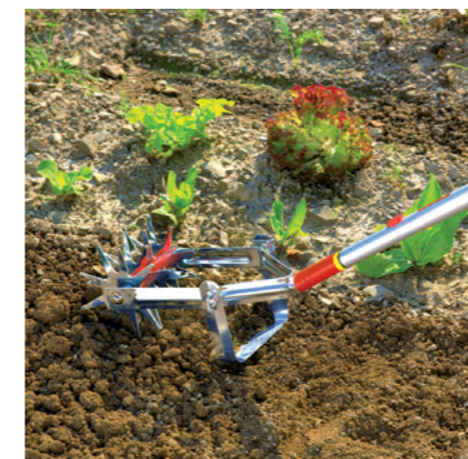
BEI DER GARTENFRÄSE jätet ein Pendelmesser, während die Fräse gleichzeitig den Boden krümelt
