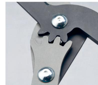
Mehr Schnittkraft wird über solche platzsparenden Zahnradantriebe ...
