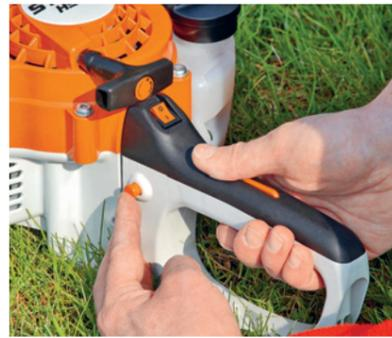
Je nach Motortyp wird die **Einstellung für den Kaltstart vorgewählt** und die Zündung eingeschaltet
