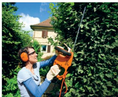
**D**as Verlängerungskabel gehört zur festen Ausstattung – und sollte deshalb in der richtigen Dimension auch gleich mit gekauft werden. Kabelgebundene Heckenschere bieten einen technisch problemlosen Rückschnitt, denn das Gerät ist sofort betriebsbereit und benötigt kaum Wartung. Die Maschinen sind vergleichsweise leicht und schlank gebaut und lassen sich daher besonders einfach führen.
