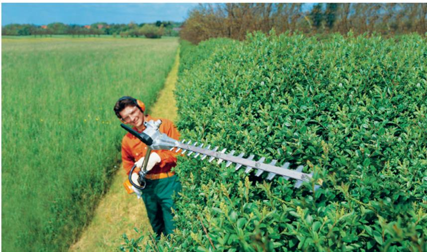
Heckenschneider erlauben den Schnitt höherer Hecken vom Boden aus. Antrieb und abwinkelbares Schneidwerk sind durch eine Verlängerung getrennt
