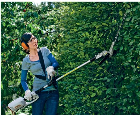
Durch die ausgewogene Bauform wird das Gerätegewicht kraftsparend am Körper getragen
