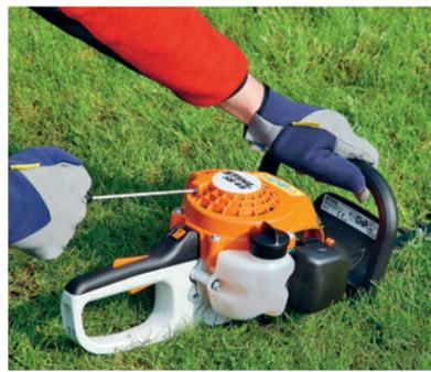
Benzinmotor per **Seilzug in langen Zügen starten**, bis das Triebwerk zündet. Dann **Gashebel betätigen**
