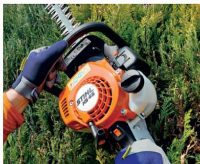
**P**rofis schwören auf den Benzinantrieb, denn er macht langes Arbeiten und einen hohen Arbeitsfortschritt ohne begleitende Infrastruktur möglich. Der Benzinmotor ermöglicht dank seiner hohen Leistung den kraftvollen Antrieb langer Schneidwerke – damit wird der Rückschnitt hoher und besonders breiter Hecken erleichtert. Das hohe Drehmoment ermöglicht zudem auch einen stärkeren Rückschnitt kräftig gewachsener Hecken in einem Durchgang – das spart Zeit.
