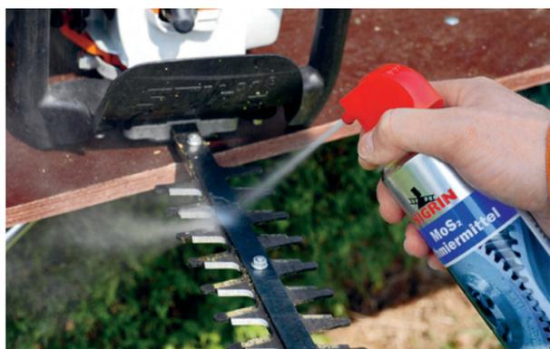
Nach der Reinigung das Schneidwerk mit Sprühöl behandeln – so verhindern Sie Korrosion und halten die Mechanik leichtgängig
