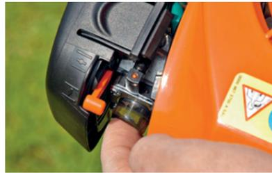
Falls erforderlich, den sogenannten **Purger betätigen** – damit wird das Benzin manuell bis in den Motor gefördert
