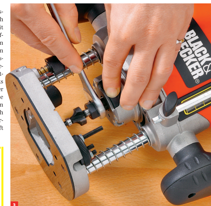
3 Fräser bis zum Anschlag einschieben, dann ein kurzes Stück zurückziehen. Knopf für die Spindelarrretierung gedrückt halten und Spanschraube mit Schlüssel festziehen
