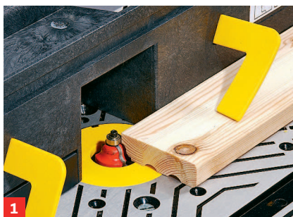
1 Auf einem Frästisch sind kleine Werkstücke besser kontrolliert führbar
