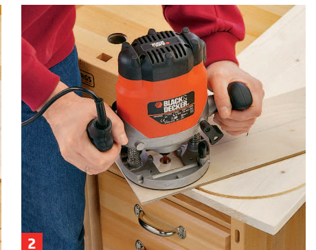
... und wird mit einem Nagel drehbar auf dem Werkstück festgeheftet
