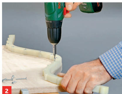
2 Das flexible Lineal aus Kunststoff muss mit Schrauben fixiert werden
