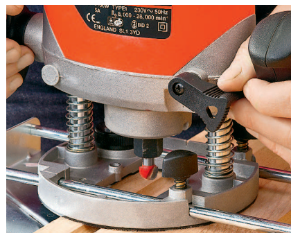
Tiefe Fräsungen in mehreren Durchgängen einbringen. Tiefe arretieren
