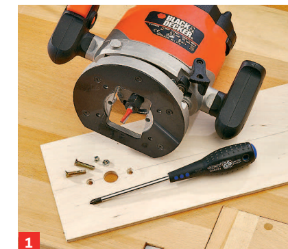
Ein schmales und dünnes Restholz-Brettchen kann als Fräszirkel dienen ...
