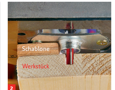
Mit Kopierring kann die Maschine an einer Schablone präzise geführt werden
