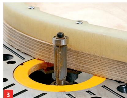
3 Mit Oberfräse (hier mit Frästisch) und Bündigfräser Form nachfräsen
