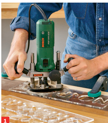
1 Solche Schriftschablonen können mit einem Kopiererring genutzt werden
