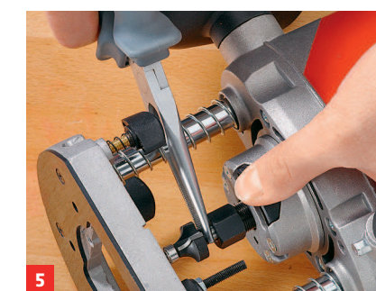
5 Klemmt der Fräser beim Lösen, vorsichtig mit einer Zange nachhelfen
