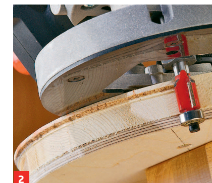
... zunächst grob ausgeschnitten und dann Zug für Zug per Bündigfräser ...
