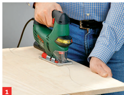
1 Linienführung zunächst per Stichsäge mit etwas Überstand ausschneiden
