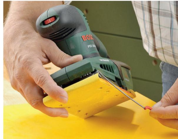
**FEINE SACHE:** Für den flächigen An- oder Zwischenschliff ist der sich in kleinen Kreisen um die Mittelachse bewegende Schwingschleifer bestens geeignet
