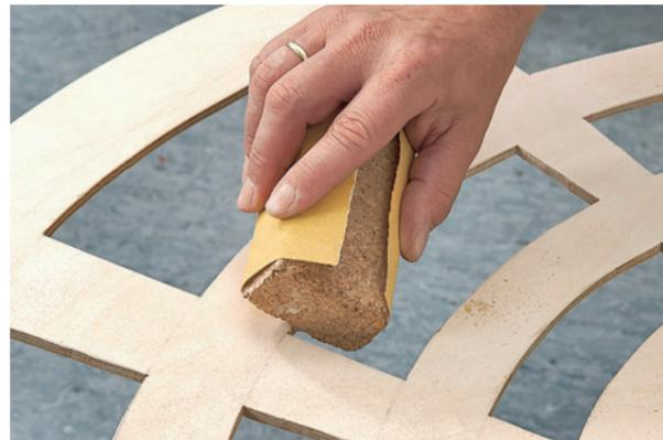
**KANTEN:** Mit einem Schleifklotz können Sie scharfe Kanten gleichmäßig brechen – wichtig ist dies insbesondere vor dem Auftrag eines Lacks
