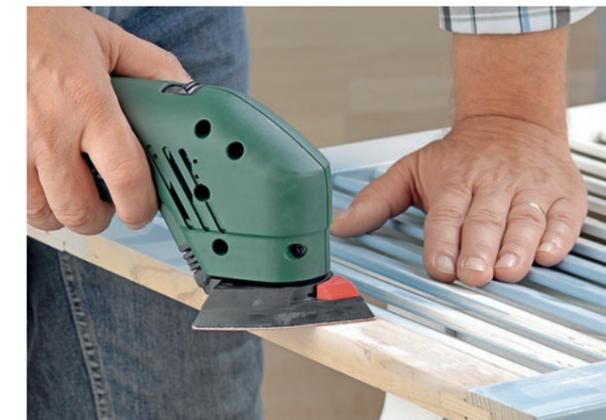
**SCHWINGT:** Der Deltaschleifer *PDA 240 E* von *Bosch* ist ein Schwingschleifer mit Regel-Elektronik und Staubsaugerstutzen für rand- und eckenbündiges Schleifen
