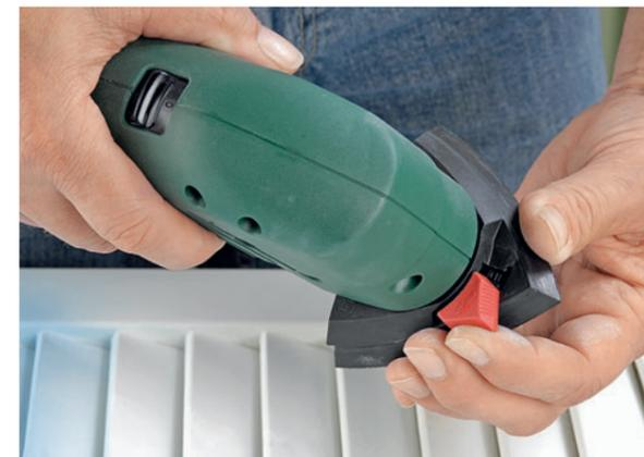
**ANSCHLUSS:** Der Delta-Schleifteller (namensgebend ist die Form) wird aufgesteckt und durch Zurückschieben des Knopfs arretiert. Schleifmittel besitzen eine Kletthaftung
