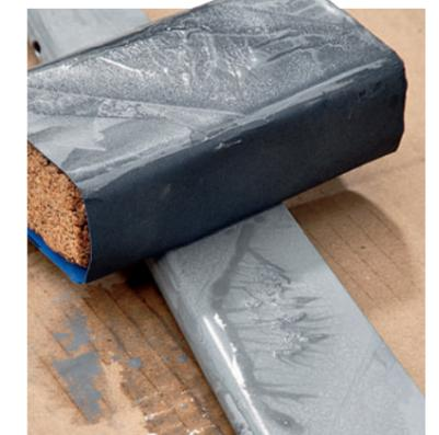
glatten Oberflächen vor allem auf metallischen Untergründen wichtig. Zum Nassschleifen nur spezielles, wasserfestes Schleifpapier verwenden!
