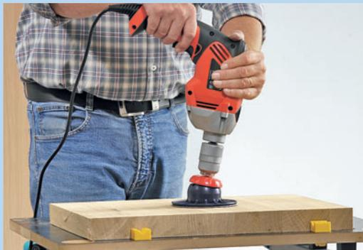
**Stützteller** sind an Bohrmaschinen einsetzbar. Erhältlich sind feste, flexible und Gelenk-Schleifteller
