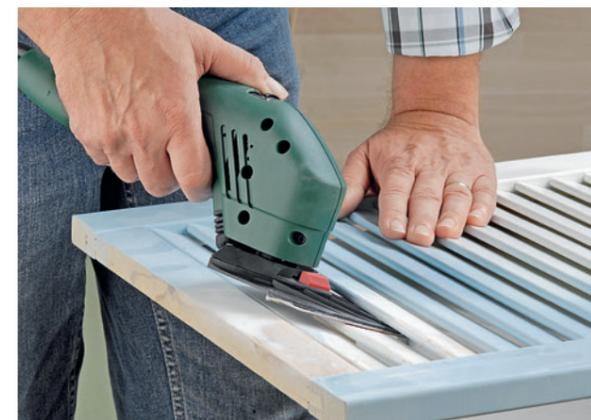
**FLACHER SCHUH:** Im Set des *PDA 240 E* von *Bosch* befindet sich ein besonders flacher Schleifschuh, mit dem sich sogar zwischen Lamellen schleifen lässt
