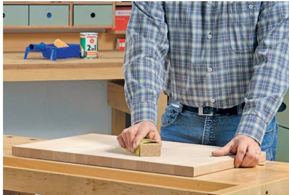
**ANSCHLIFF:** Mit Schleifpapier und Korkklotz können Sie auch per Hand ein sehr gleichmäßiges Schleifbild erzielen. Immer in Richtung der Maserung arbeiten!
