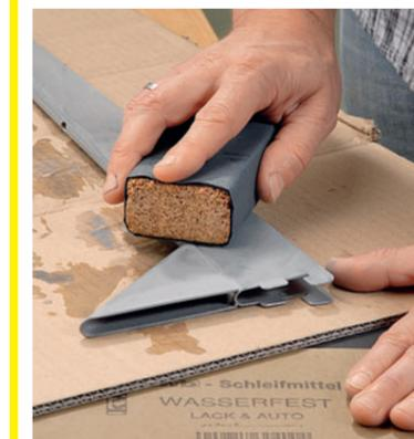
Nassschleifen hat den Vorteil, dass Riefenbildung auf der Oberfläche durch festsetzenden Schleifstaub in der Regel verhindert wird. Dies ist bei sehr
