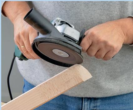
**Winkelschleifer** mit Lamellen-Schleiftellern sind auch zur Holzbearbeitung geeignet
