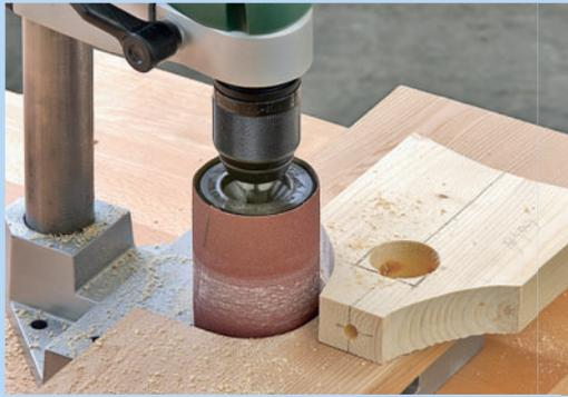
**Schleifrollen und Lamellenschleifer** eignen sich für die Bearbeitung geschweißter Werkstücke und Kanten. Rollen ermöglichen gröberen, Lamellen feineren Abtrag
