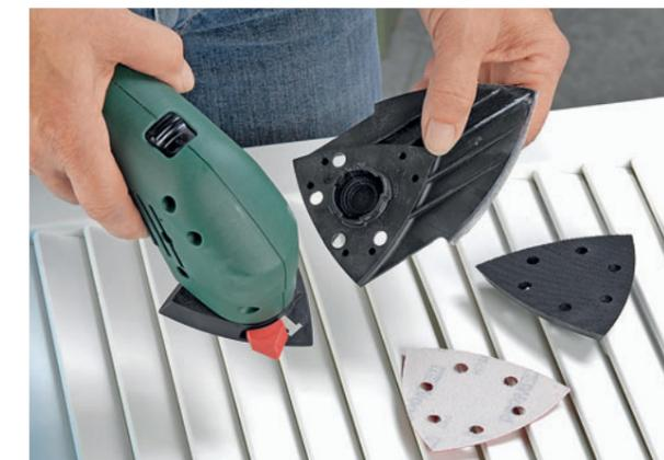
**LEICHTER AUSTAUSCH:** Wird der rote Verriegelungsknopf zur Seite geschoben, lässt sich der zur Zeit verwendete Schleifaufsatz einfach nach unten abziehen
