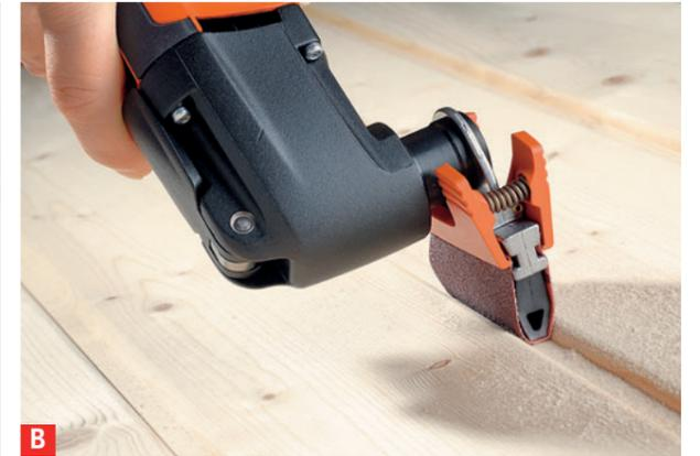
Multischleifer werden von mehreren Herstellern angeboten. Bekanntester Anbieter ist die Firma Fein mit dem Multimaster. Für dieses Gerät sind auch die Profilschleifaufsätze **A** für konkave mit werkzeuglosem Wechsel) erhältlich. Funktionsprinzip ist das schnelle Hin- und Her-
