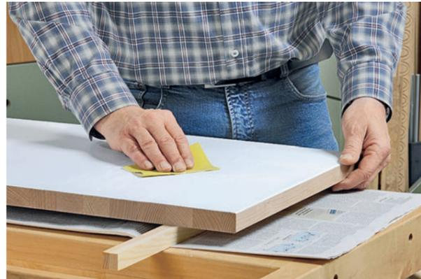
**ZWISCHENSCHLIFF:** Ist nur wenig Abtrag gewünscht, z. B. vor einem zweiten Lackauftrag, verwenden Sie am besten Schleifpapier mit direktem Handkontakt
