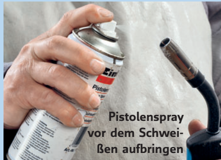
Kommt es dennoch zu Anhaftungen, hilft ein solcher Düsenreiniger beim Säubern
