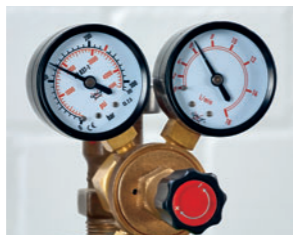
Druckminderer: Er zeigt Flaschendruck und Durchflussmenge
