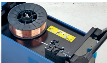
Schweißdraht: Für Nachschub sorgt die im Inneren liegende Vorratsrolle
