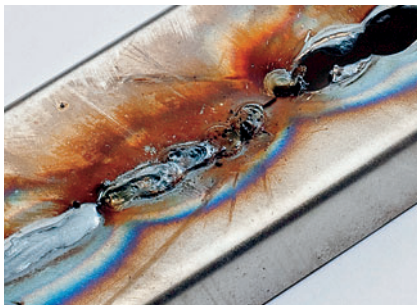
Zu wenig Gas: Starkes Spritzen, die Naht ist unregelmäßig, Brandspuren
