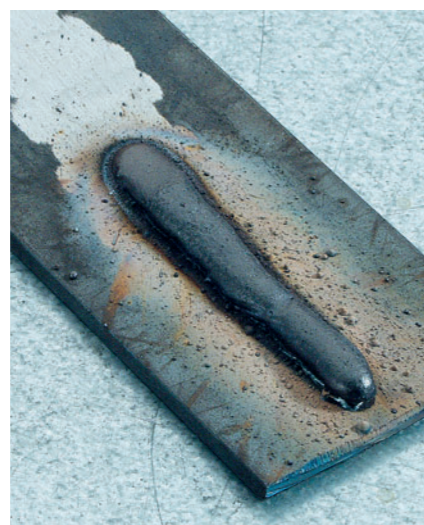
Schweißstelle vor Beginn der Arbeit blank schleifen oder schrappen. Die Schweißnaht wird beim Elektroden-schweißen von Schlacke überzogen, diese wird dann mit dem Schlacke-hammer abgeklöpft
