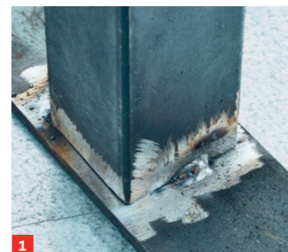
1 Nach dem Blankschleifen werden die Werkstücke erst gepunktet ...
