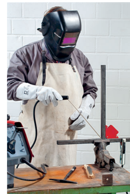
SCHWEISSHELM: Er erlaubt ein beidhändiges Arbeiten, denn das Schutzglas wird während des Schweißvorgangs automatisch blitzartig abgedunkelt. Diese optoelektronische Haube von Einhell kostet rund 100 Euro.
