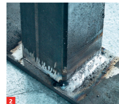
2 ... und noch einmal gerichtet. Dann Nähte durchschweißen
