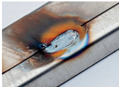
Zu geringer Drahtvorschub: Schmauchspuren, Gefahr des Durchbrennens
