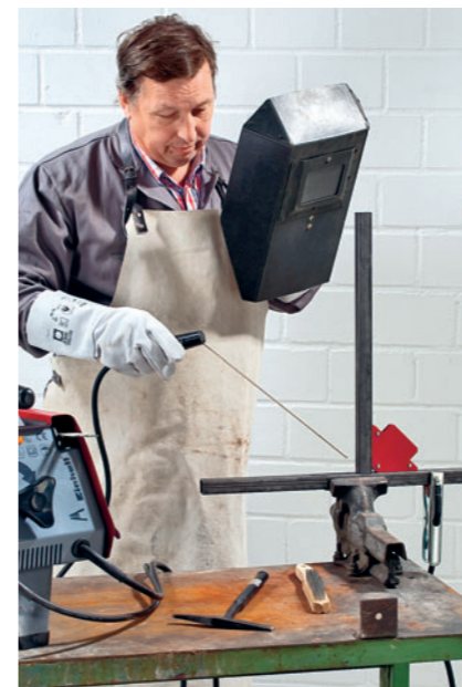
HANDSCHILD: Ein Handschild ist preiswert (rund 20 Euro), bindet aber eine Hand und erfordert etwas Übung bei der Anwendung. Eine Schweißbrille genügt übrigens nicht, denn die UV-Belastung der Haut wäre zu groß.
