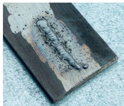
SCHWEISSSTROM ZU SCHWACH: Die Schweißnaht liegt weitgehend auf der Oberfläche des Werkstücks, die Verbindung des Materials ist dann nicht stark genug
