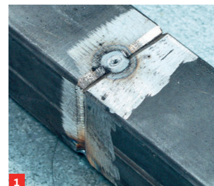
1 Auch hier die blanken Verbindungsstellen zunächst anpunkten, ...
