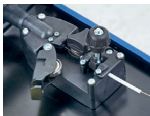
Vorschub: Der Schweißdraht wird aus dem Gerät in das Schlauchpaket gefördert
