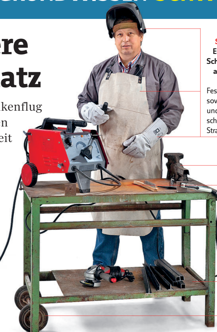
Ein solcher Schweißplatz aus Metall oder eine Metallplatte auf einem Werkisch bieten einen sicheren Arbeitsplatz. Praktisch: Schraubstock und Räder
