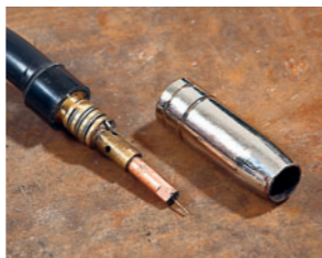
Brenner: Eine aufgesteckte Düse sorgt für gleichmäßigen Gasfluss
