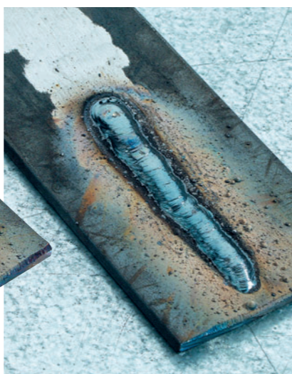
Unter der Schlackeschicht sichtbar: Die vorbildlich geschweißte glatte, gering erhabene Schweißraupe. Diese kann nun mit einer Schrupp-scheibe geglättet werden, dann tritt das blanke Metall wieder hervor
