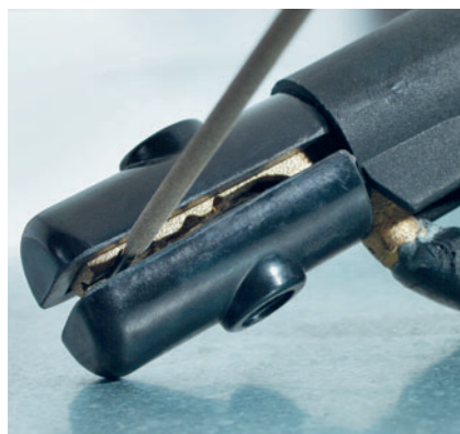
Die Elektrode ist am Ende nicht umhüllt, damit der Strom aus dem Elektrodenhalter übertragen wird
