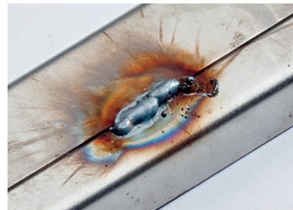
Zu hoher Drahtvorschub: Starke Brandspuren, starke Spritzer
