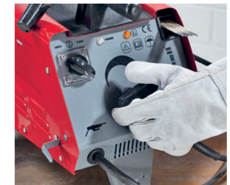
Bei der Vorwahl der Stromstärke wird der Trafokern mechanisch bewegt
