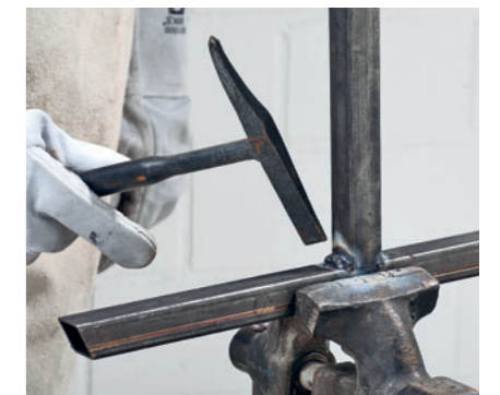
Nach dem Schweißvorgang muss die Schlacke abgeklopft werden
