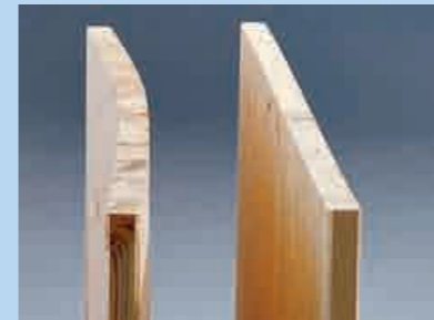
SCHÜSSELN: Entsteht durch Schwund bei Leisten oder schlechtem Leimholz. Bei leichter Verformung akzeptabel
