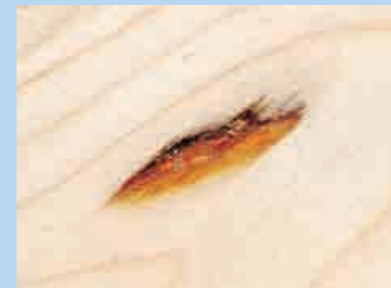
HARZGALLEN: Unschön bei sichtbaren Oberflächen; verschmutzen das Werkzeug. Ansonsten unkritisch
