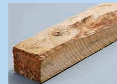
WALDKANTE: Runde Kanten oder Rindenreste. Schönheitsfehler. Ist bei günstigem Bauholz akzeptabel
