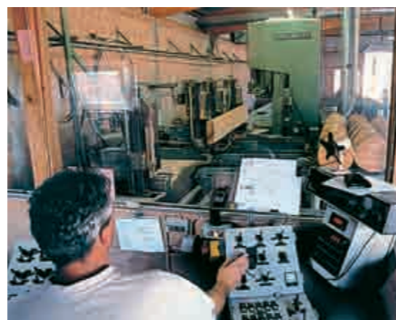
Hier werden die Stämme automatisch zersägt. Bei Schnittholz geschieht dies parallel zur Längsachse
