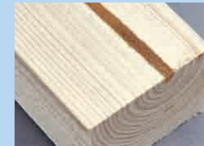
MARKRÖHREN: Sollten nicht sein: Bei kompletter Querschnittsnutzung besser auf den Kauf verzichten
