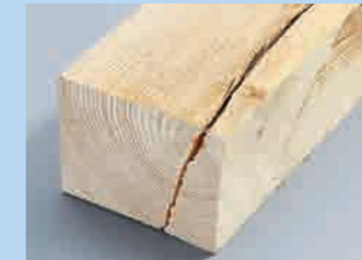
TROCKNUNGSRISSSE: Fehler in der Holzstruktur. Leisten und Latten werden dadurch unbrauchbar
