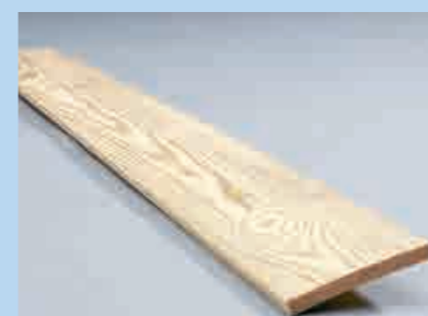
DREHWÜCHSIGKEIT: Spiralförmige Verformung, die durch Wachstums- spannung entsteht. Finger weg!
