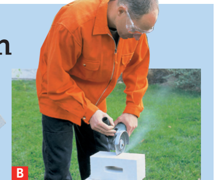
B Kalksandsteine, Ziegel, Natursteine kann man per Winkelschleifer trennen
