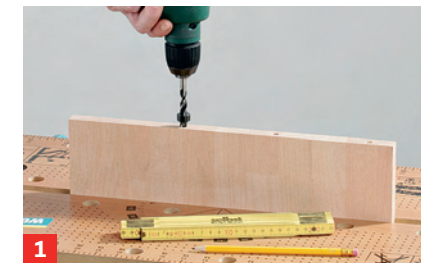
1 Führen Sie immer zunächst senkrecht die Bohrungen im Kopfholz aus
