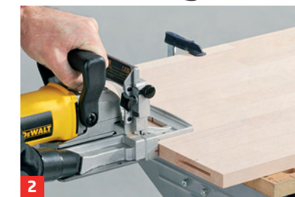
2 ... markieren. Die Fräse auf das Dübelmaß einstellen und die Nuten erst in ...
