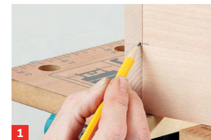
1 Zu verbindende Werkstücke zusammenstellen und Dübelpositionen ...
