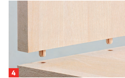
4 Dübel unter Leimzugabe einsetzen und Bauteile bis zum Abbinden verpressen
