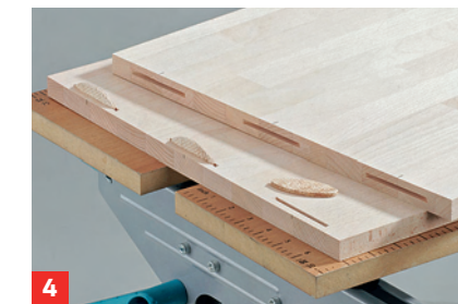
4 Leim dosiert sowohl in die Nuten als auch auf die Kontaktflächen geben
