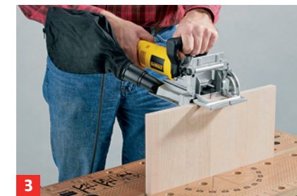
3 ... die Kopfholzfläche fräsen. Im Anschluss wird die Fläche genutet
