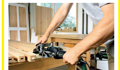
2 ... markieren. Die Fräse auf das Dübelmaß einstellen und die Nuten erst in ...
