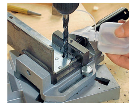
Kleine Bohrungen können aus einer handlichen Plastikflasche gekühlt werden
