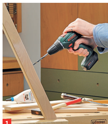
SCHRÄGE BOHRUNG: Material zunächst rechtwinklig anbohren, erst nach einigen Millimetern Tiefe ...
