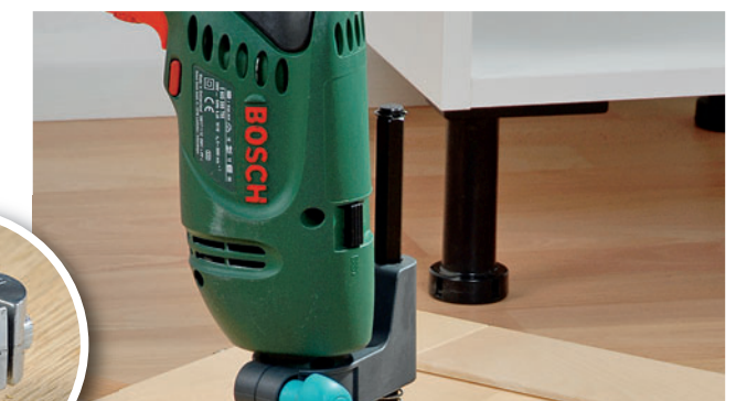
Bohrmobile sind die leicht transportable, variable Alternative zum Bohrständler (Wolfcraft Tecmobil 200, ca. 16 Euro)
