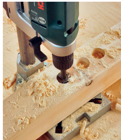
GROSSE DURCHMESSER mit geringerer Drehzahl und wenig Anpressdruck bohren, zur Kühlung in Etappen arbeiten
