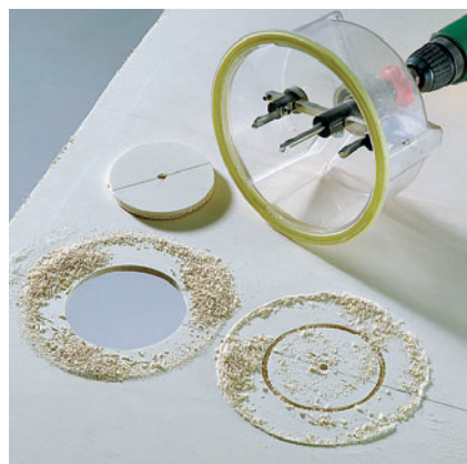
BOHRKRONEN: Ein gehärteter oder hartmetallbestückter kreisrunder Zahnkranz sägt einen bestimmten Durchmesser
