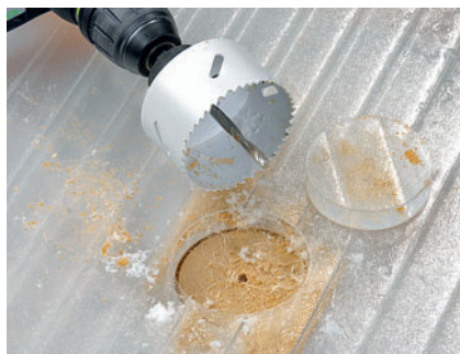
BOHRKRONEN: Ein gehärteter oder hartmetallbestückter kreisrunder Zahnkranz sägt einen bestimmten Durchmesser
