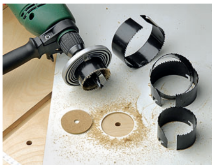
LOCHSÄGEN: Wechselbare flexible Zahnkränze werden auf einem Träger montiert – eher eine Notlösung
