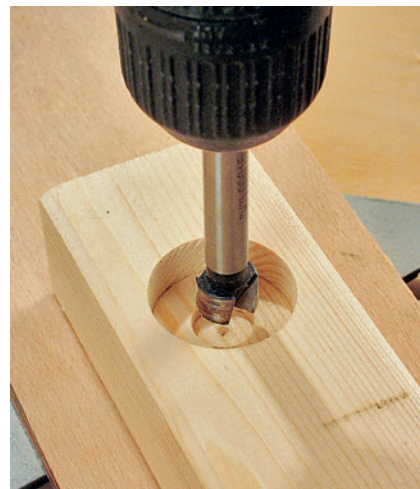
VERSENKTE BEFESTIGUNG: Für zurückgesetzte Schraubenköpfe erst das Sackloch mit großem Durchmesser bohren
