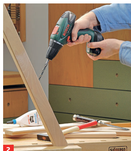
... die laufende Maschine in den gewünschten Bohrwinkel bringen und gesamte Tiefe einbringen
