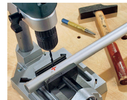
Ankörnen der Bohrstelle: So greift der Bohrer besser, Verlaufen wird verhindert
