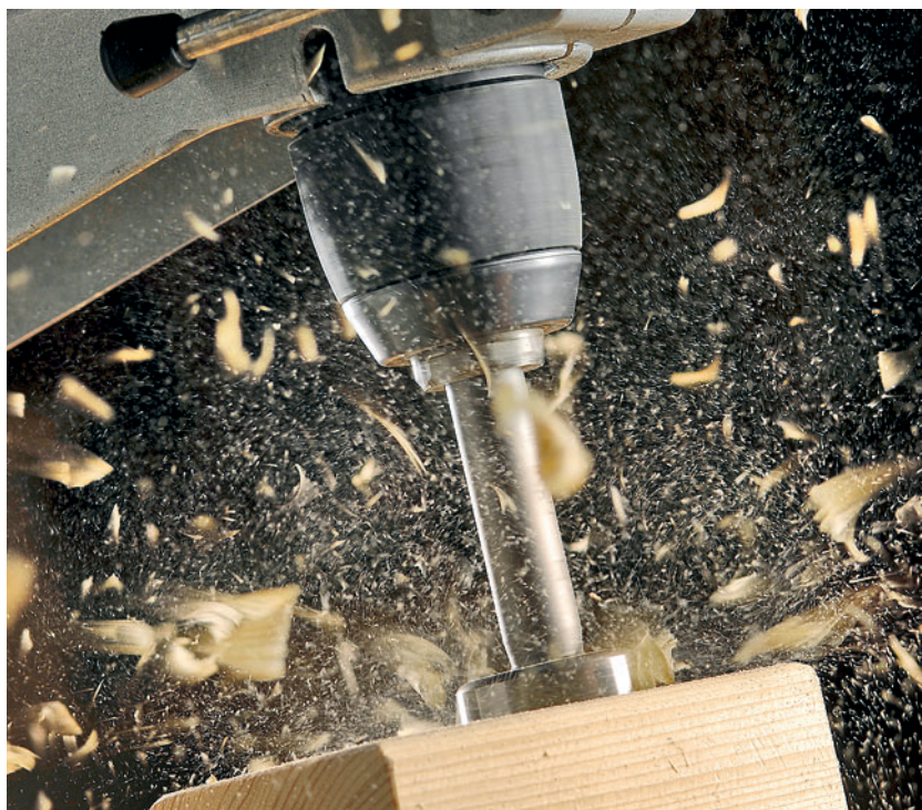
LOCHSCHNEIDER: Noch größere Durchmesser werden mit einem solchen verstellbaren Schneidgerät gebohrt
