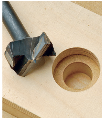
LÖCHER AUFWEITEN: Mit einer Zulage erhält ein größerer Forstnerbohrer Halt im zuvor kleineren Bohrloch
