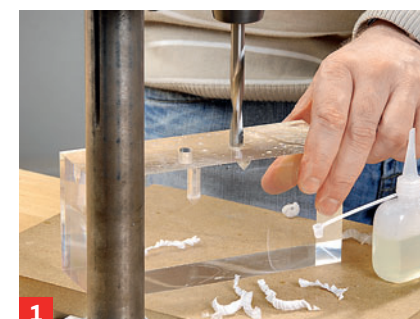
Plexiglas mit sanftem Druck bohren. Am Spanfluss können Sie den ...
