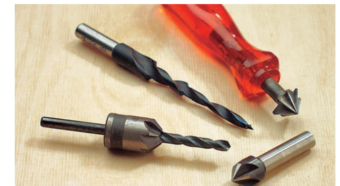
Senker gibt es als Handwerkzeug und Bohrzubehör. Stufenbohrer (Mitte) sind für Conformat-Schrauben erforderlich
