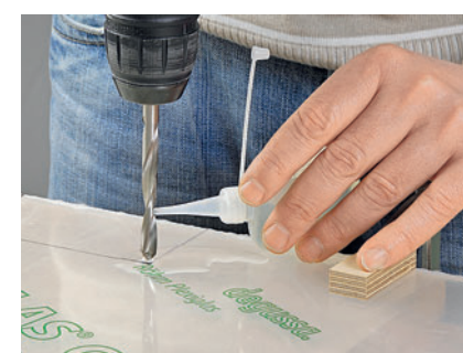
Kühlung: Bei Kunststoff Leitungswasser mit etwas Spülmittel verwenden
