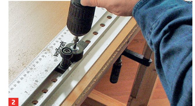
2 ... Bohrhülle schützt dabei die Schiene vor Verletzungen durch den Bohrer (Dübelleiste von Wolfcraft, ca. 45 Euro)
