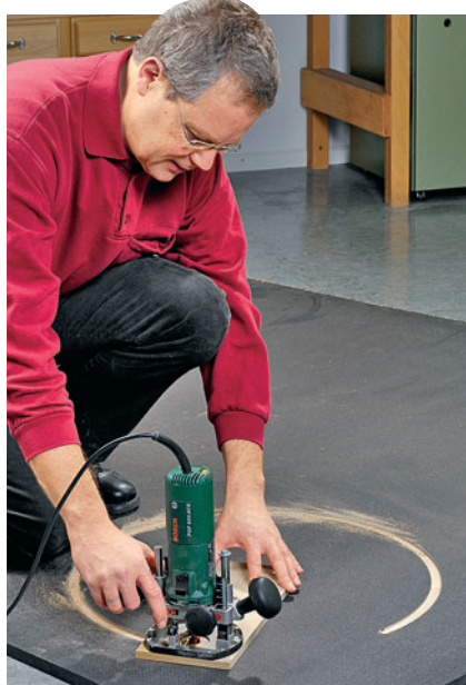
OBERFRÄSE: Mit einem Fräszirkel oder einer selbst gebauten Zulage können sehr große Abschnitte hergestellt werden
