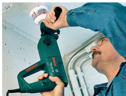
Beton am besten mit speziellen Hammer-Bohrmaschinen bearbeiten
