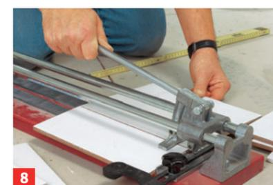
**8** Mittels Fliesenschneidemaschine können Sie leicht gerade Schnitte verwirklichen
