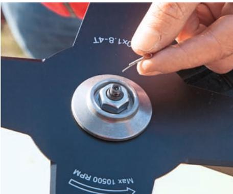
**SICHERUNG:** Splint statt Sicherungsmutter – eine fummelige Lösung.
