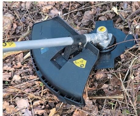
**SCHUTZ:** Hier (bei Einhell) stört der große Prallschutz beim Schnitt.
