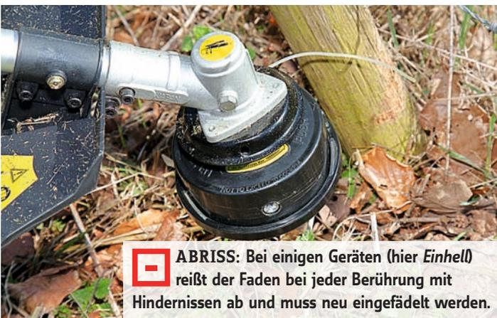
**ABRISS:** Bei einigen Geräten (hier Einhell) reißt der Faden bei jeder Berührung mit Hindernissen ab und muss neu eingefädelt werden.
