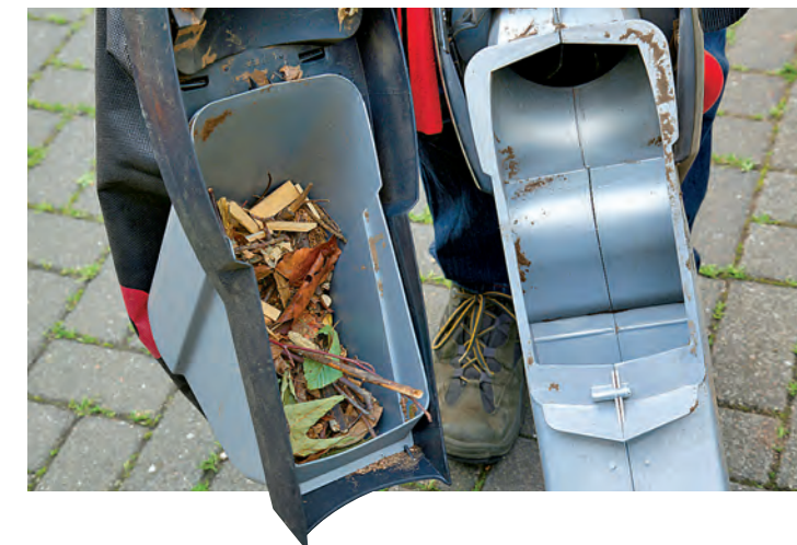
+ EINBLICK: Bei Einhell sieht man den Füllstand des Sammelsacks.
