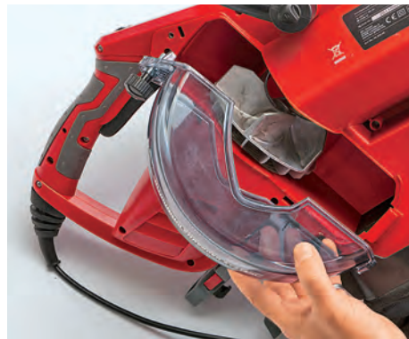
+ ZUGÄNGLICH: Bei Einhell ist das Lüfterrad gut erreichbar.
