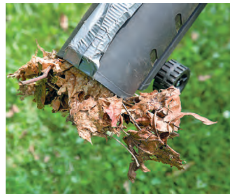
- VERSTOPFT: Bei größeren Laubmengen blockierten einige Sauger.
