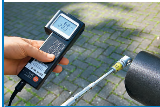
Die maximale Luftgeschwindigkeit wurde in kurzem Abstand vor dem Luftein- und Austritt ermittelt.
