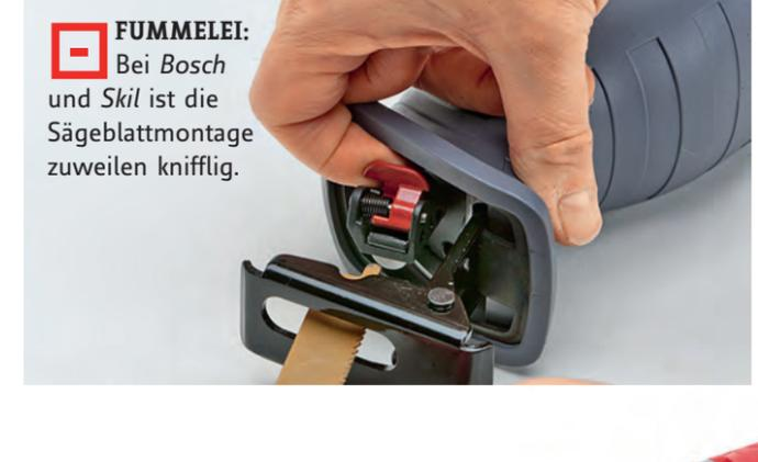
**- FUMMELEI:** Bei *Bosch* und *Skil* ist die Sägeblattmontage zuweilen knifflig.
