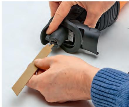
**+ BEQUEM:** Mit großem Drehknopf ist das Blatt bei AEG leicht montiert.
