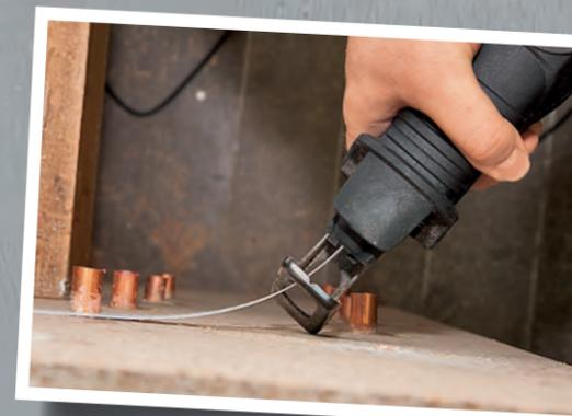
**BÜNDIGES ABTRENNEN** ist eine Spezialität der Säbelsäge. Lange Sägeblätter sind äußerst flexibel.
