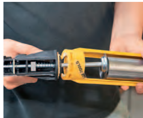
ZERSTÖRT: Diese Lux-Pistole brach beim Belastungstest entzwei.
