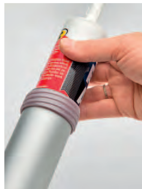
ROHR: Geschlossene Pistolen sind auch mit Standard-Kartuschen nutzbar.
