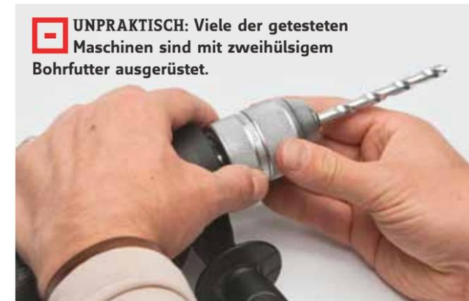
**UNPRAKTISCH:** Viele der getesteten Maschinen sind mit zweihülsigem Bohrfutter ausgerüstet.
