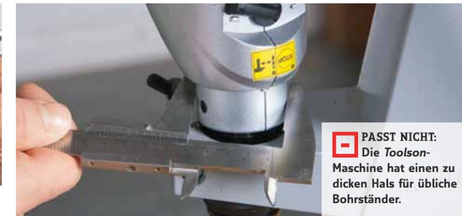
**PASST NICHT:** Die Toolson-Maschine hat einen zu dicken Hals für übliche Bohrständer.
