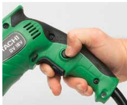
**DAUERLAUF:** Der entsprechende Schalter ist oft schwer greifbar.
