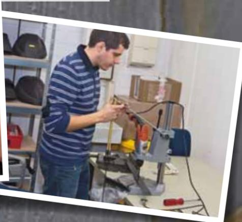
**BOHRVERSUCHE:** Beim TÜV Rheinland wurde mit den Maschinen bei gleichem Anpressdruck praktisch gebohrt.
