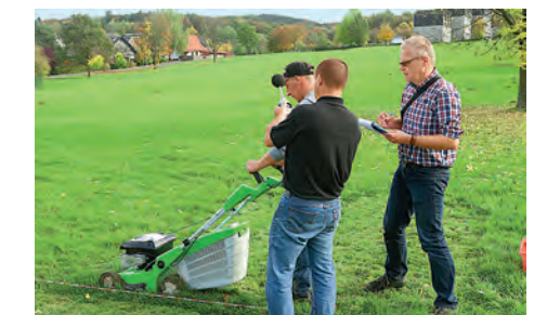
Die Lärmbelastung haben wir am Ohr des Benutzers im Leerlauf gemessen.
