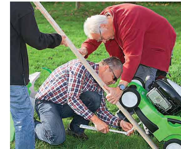
Um vergleichbare Mähergebnisse zu erzielen, wurden alle Mäher auf eine einheitliche Schnitthöhe eingestellt.
