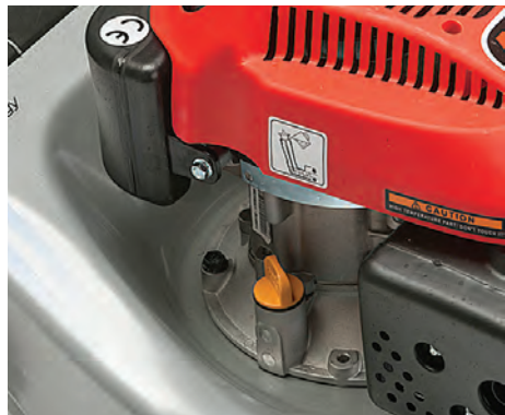
VERDECKT: Bei einigen Motoren ist das Nachfüllen von Öl knifflig.
