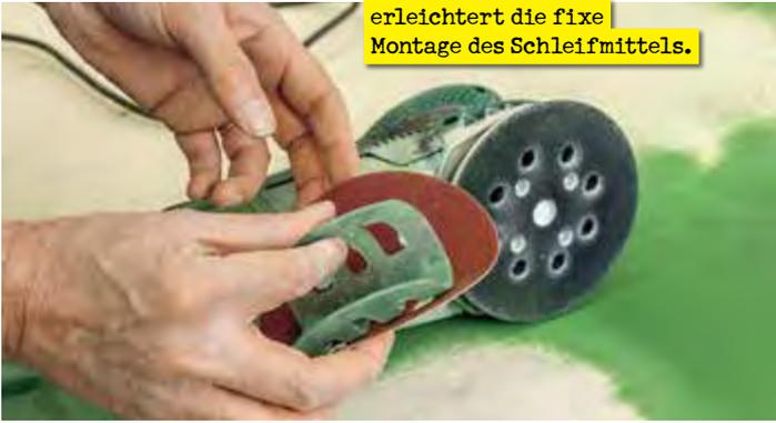
**+ CLEVER:** Die gerundete Positionierhilfe unterstützt den Anwender dabei, die Lochung des Papiers mit den Bohrungen des Tellers zu fluchten.
