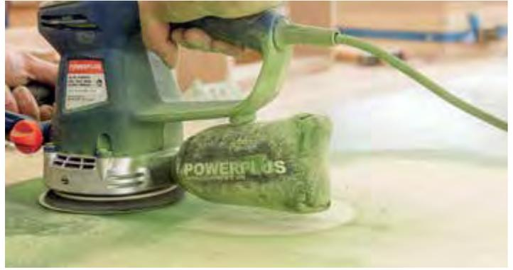
**- FUNKTIONSLOS:** Bei Varo wird der Schleifstaub durch den Staubsack einfach hindurchgeblasen.
