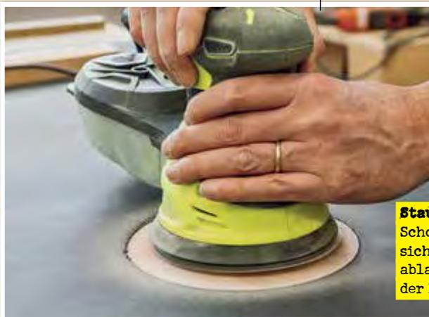
**Staub-Emission:** Schon nach kurzer Zeit zeigten sich meist deutliche Staubablagerungen im Arbeitsbereich der Exzenterschleifer.
