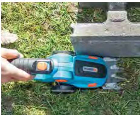
— BREMSE: Seitlich überstehende Räder hemmen bei Gardena den Vortrieb.
