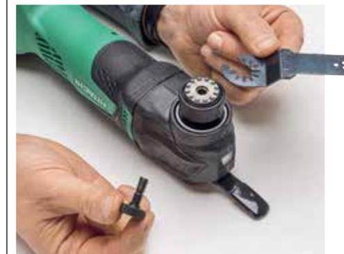
**-** **KNIFFLIG:** Werkzeuglos, aber etwas fummelig ist die Montage bei *Hitachi*.
