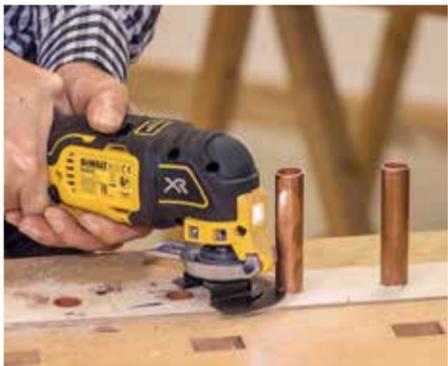
**-** **STÖRT:** Die Sägeblattbefestigung behindert bei DeWalt den Schnitt.
