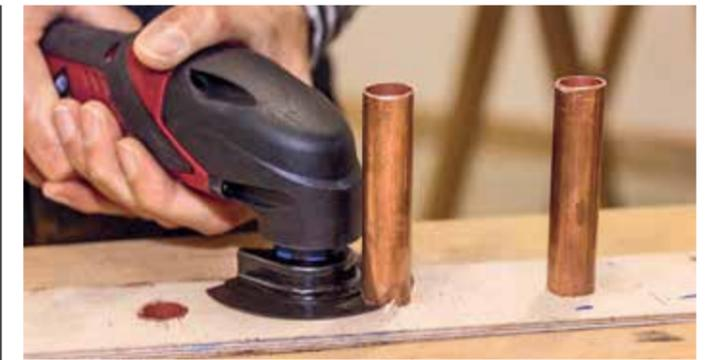
**-** **VIBRATION:** Extrem starke Schwingungen traten beim Sägen von Kupferrohren auf – hier bei *Einhell*, aber auch bei *Stanley*.
