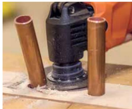
**-** **SCHRÄG:** Bei Fein erschwert das nicht plan aufliegende Sägeblatt den Schnitt.
