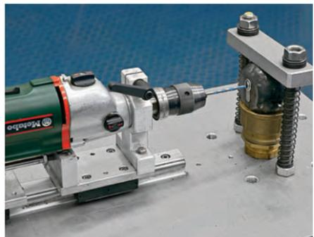
**Bohren auf dem Prüfstand** DIN-gerecht, aber nicht besonders realistisch: Bohren mit starr geführter Maschine
