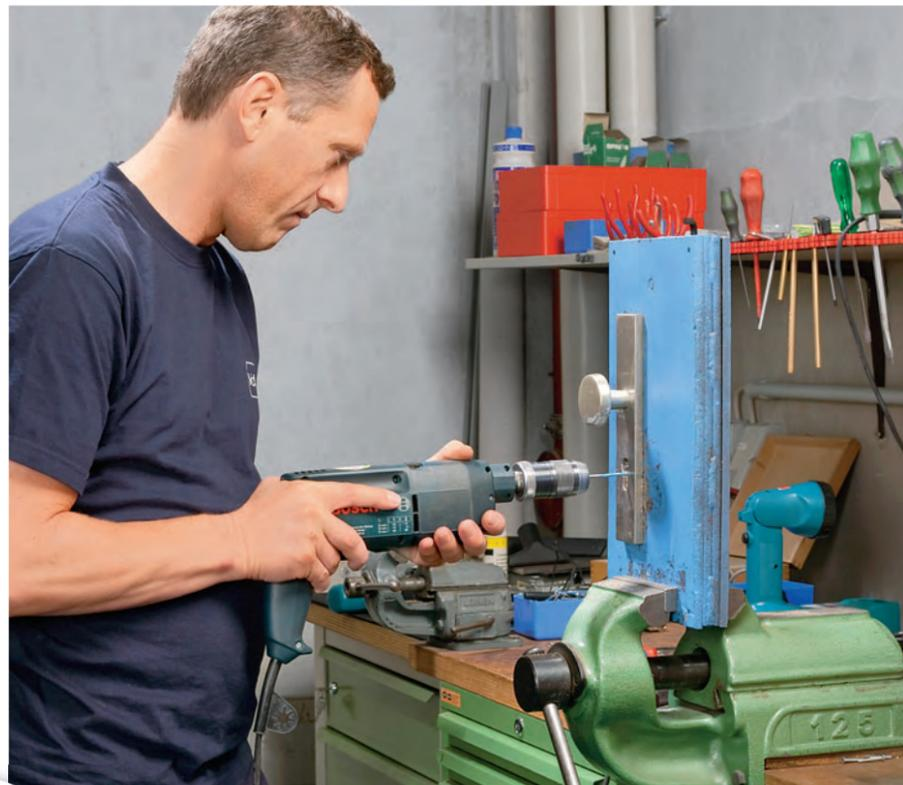
**VdS-gerechte Bohrprüfung per Hand** Bohren wie die Einbrecher gelingt aus der Hand realitätsnäher als auf dem Prüfstand. Hochwertige Zylinder halten mehr als sechs Minuten Stand – so lange versuchen es Einbrecher meistens nicht
