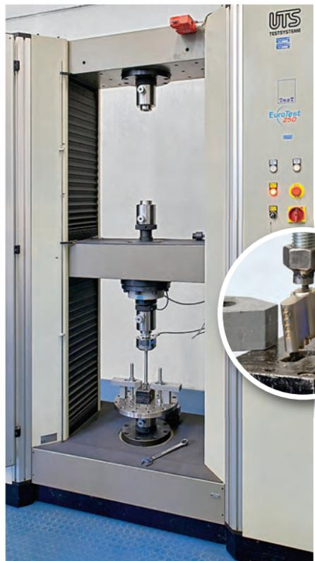
**Ziehen auf dem Prüfstand** Eine ansteigende Zugkraft wirkt auf den montierten Zylinder ein, bis er sich herauszieht
