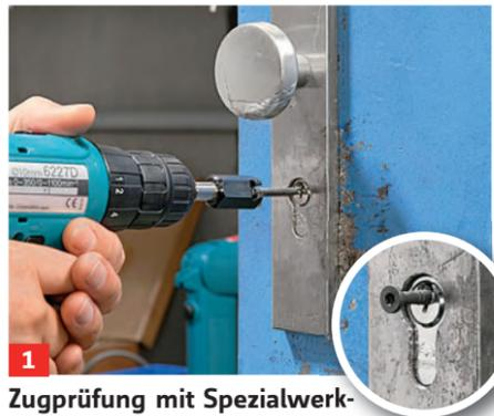
**1** **Zugprüfung mit Spezialwerkzeug** Zunächst wird eine Schraube in den Zylinder gedreht. Sollte schon das ...
