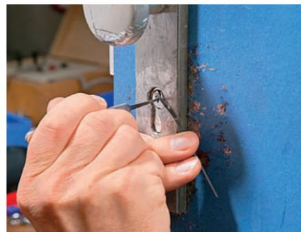
**Spezialwerkzeug** Mit kleinen Stiftwerkzeugen wird versucht, Zylinder aufzuschließen; bei billigen für Kenner kein Problem
