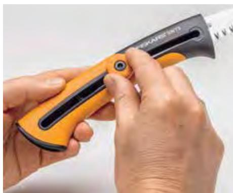
**- SCHRAUBE:** Sie trägt deutlich auf und war nach dem Falltest nicht mehr lösbar.
