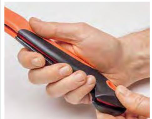
**- STÖRENDE:** Bei einigen Klappsägen (hier *Werknorm*) stört die Griffnut.
