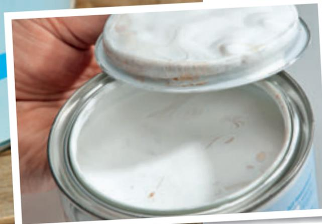
**Es kommt nicht nur auf den Inhalt an: Zwei Lacke zeigten bereits beim ersten Öffnen Korrosionsverfärbung**
