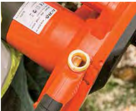
ENGSTELLE: Bei Ikra ist die Einfüllöffnung für Sägekettenöl sehr stark verengt.
