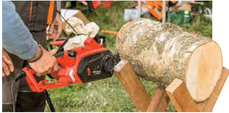
ZEITMESSUNG: Bei dieser Messung (gezeigt mit Hurricane ) wurde die Maschine mit einem definierten Andruckgewicht am vorderen Griff belastet.
