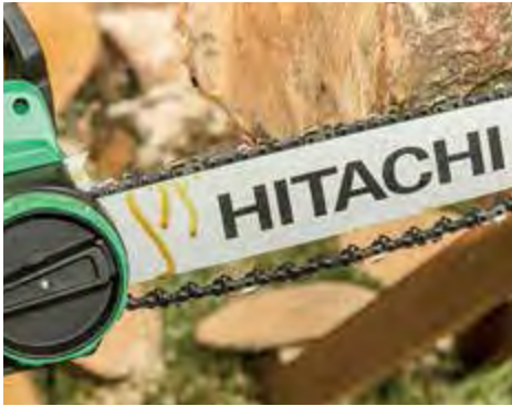
ENTSPANNT: Bei vielen Sägen ließ die Kettenspannung nach wenigen Schnitten nach.
