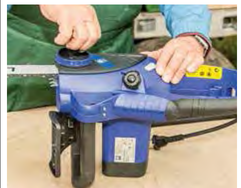
+ PRAKTISCH: Die Lux -Maschine steht zur Kettenmontage auf dem Motorgehäuse.
