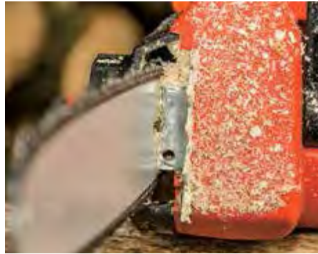
VERSCHMUTZT: Bei Schnitten in Faserrichtung kann sich die Kettenführung zusetzen.
