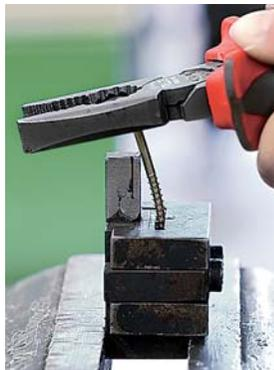
**Biegetest:** Die Schraube muss einen Biegewinkel von 15° ohne Schäden überstehen
