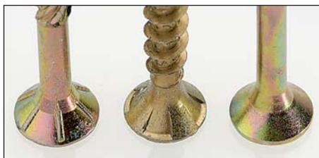
**RIPPEN** oder Aussparungen wirken an der rotierenden Schraube wie ein Senker und brechen die Holzfasern – dadurch wird Platz für den Senkkopf geschaffen. Bei Standardschrauben (rechts) fehlt diese Ausstattung
