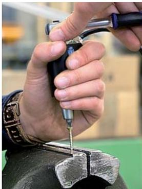
**Drehmoment-Prüfung:** Mit einer Knarre wird die Antriebsenergie allmählich bis zum Bruch gesteigert
