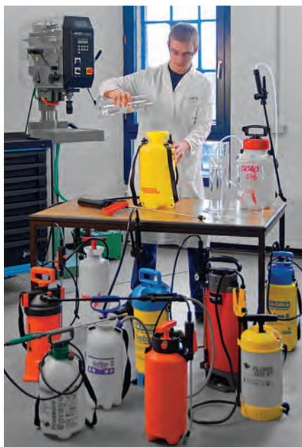
**LABORTEST:** Dichtigkeit, Füllstandsanzeige und Sprühmenge wurden im VPA-Labor von Daniel Napieraj ermittelt
