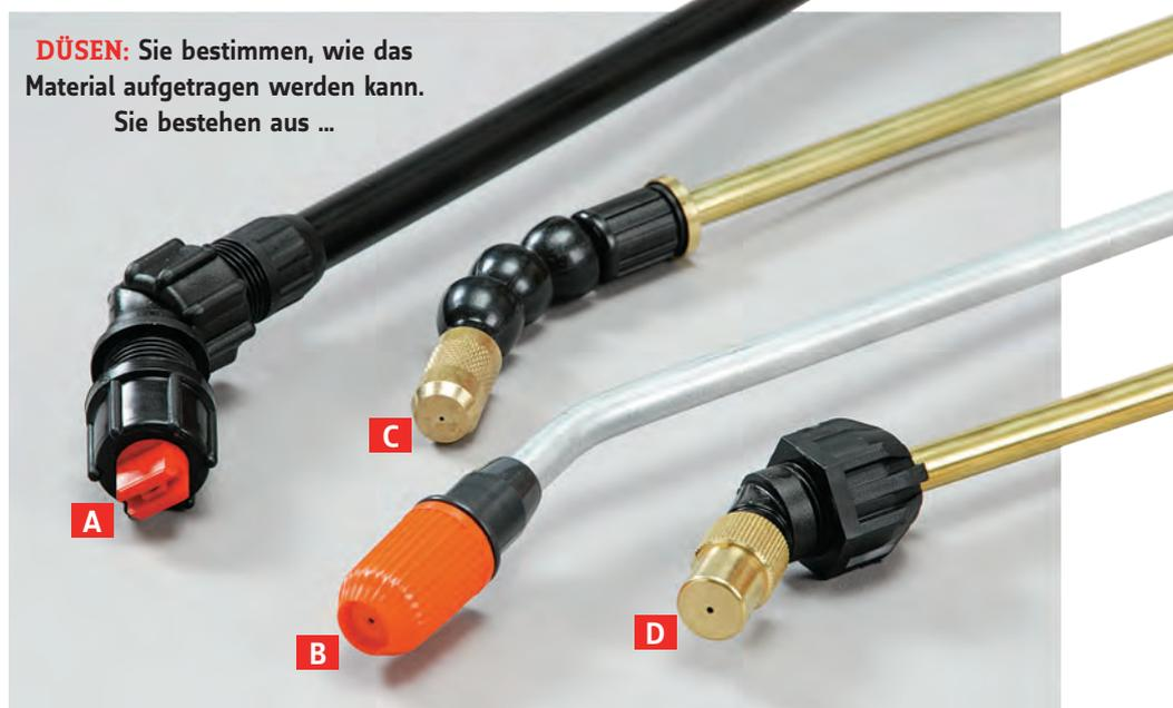
... Kunststoff und sind nicht verstellbar **A** oder verstellbar **B**. Düsen aus Messing sind in Strahlbreite und Neigung justierbar **C** oder nicht verstellbar und statisch in der Neigung **D**
