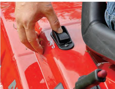
**BEQUEM**, aber langsam: Beim Al-Ko-Traktor kann der Fangkorb elektrisch angehoben und damit entleert werden
