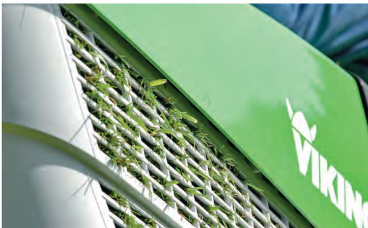
**STAUBIG:** Die große Maschenweite des Viking-Fangkorbs kann an trockenen Tagen zu Belästigungen durch Staub und Fanggut führen
