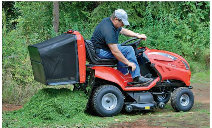
**KLAPPERN** gehörte beim Partner-Traktor zum Mähen – durch Vibrationen ging eine Dichtlippe am Korb verloren
