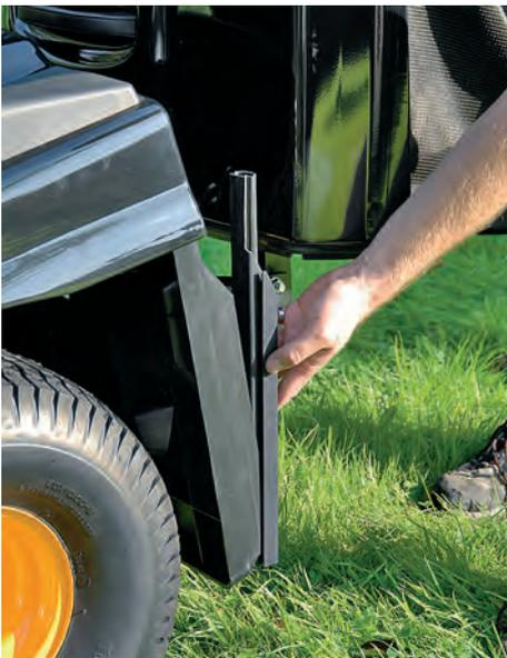
**HEBELKRAFT:** Die Entleerung des Fangkorbs über einen ausziehbaren Hebel bewährte sich bei allen getesteten Rasentraktoren
