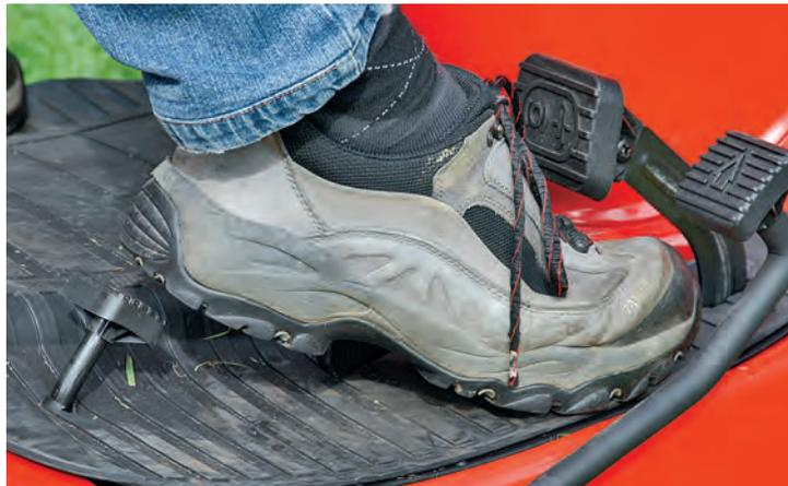
**VERRENKEN** muss der Anwender sein Fußgelenk, um an den Traktoren von Al-Ko und Solo den Rückwärtsgang zu bedienen
